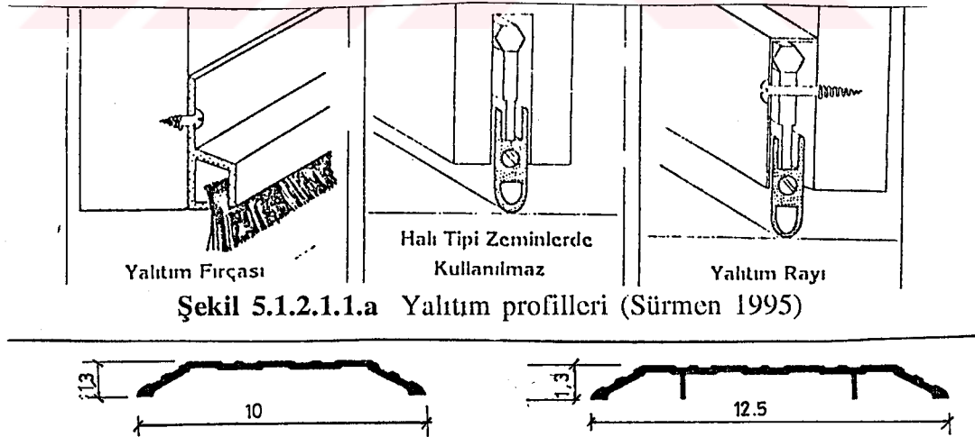
Şekil 5.1.2.1.1.b İki tarafı eğimli eşik (Leibrock 1992)
