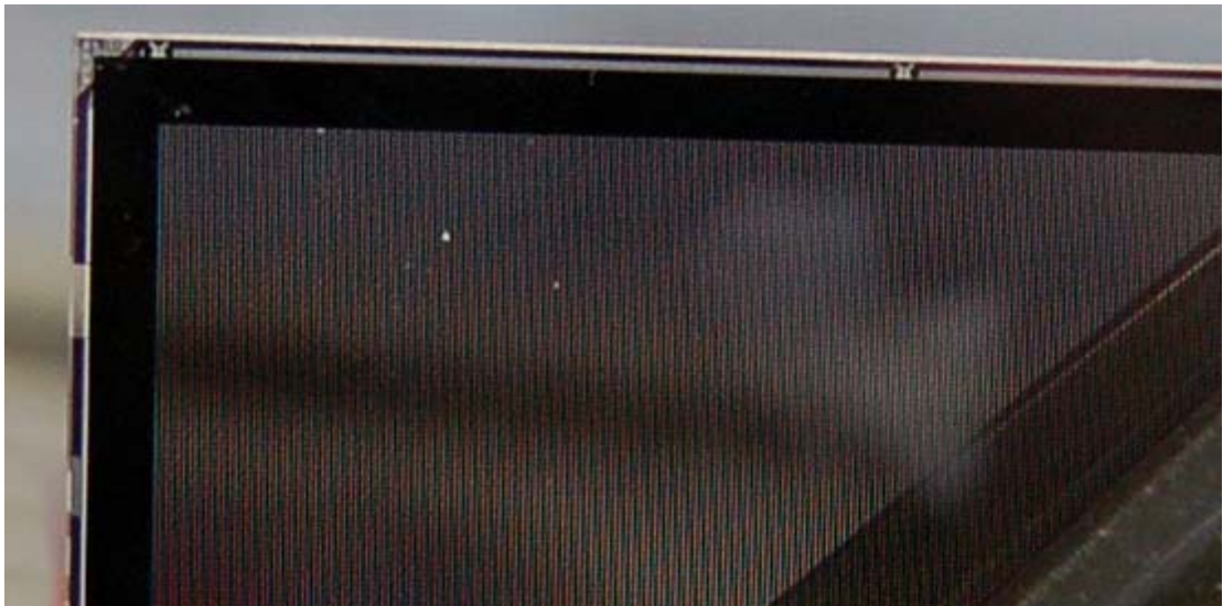
Görüntü 2-1: SBG görüntülük üzerinde fosfor tabakaları çok zor algılanabilen satır ve sütunlar halinde dizilmişlerdir.
