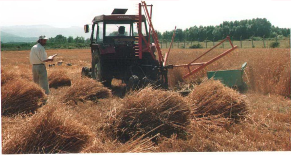
Şekil 3.2.1.1.6. Kanatlı orak makinası ile buğday hasadı
