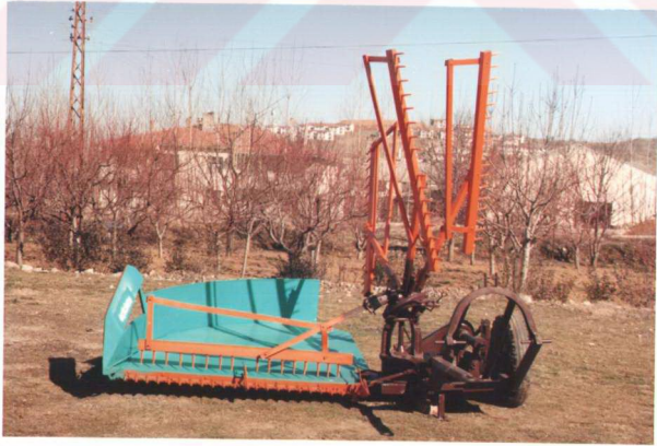
Şekil 3.1.3.2.1. Kanatlı orak makinası
