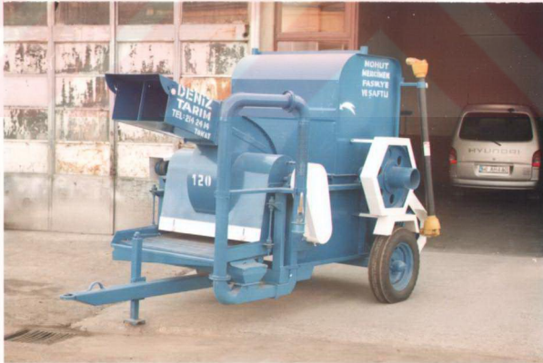
Şekil 3.1.3.3.1. Sapsedöver harman makinası
