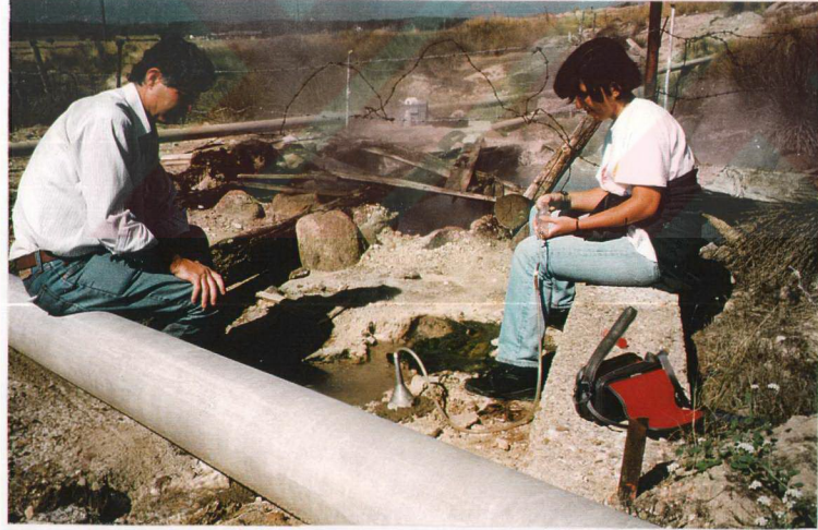
Şekil 5.39. Eynal sıcaksu kaynağından gaz numunesi alımı.
