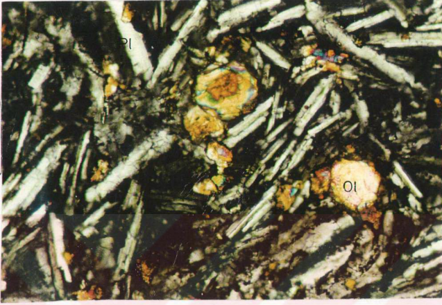
Şekil 4.12. Bazaltlardan genel bir görünüm. İddingsitleşmiş olivin (Ol) ve plajiyoklas (Pl) mikrolitleri (Çapraz N, 190x).
