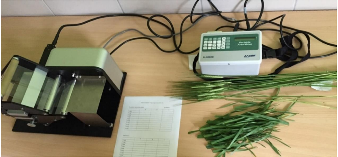
Şekil 3.3. Yaprak alanı ölçer cihazı (LICOR LI-3000C) ve yaprak alanı ölçümü
