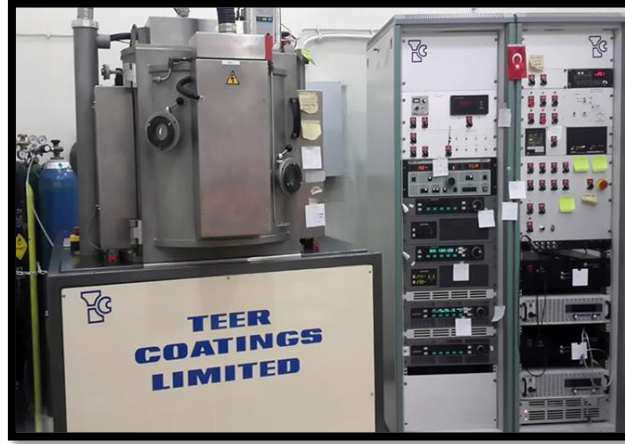
Şekil 3.3. İnce film kaplamaların yapıldığı PVD kaplama cihazı
