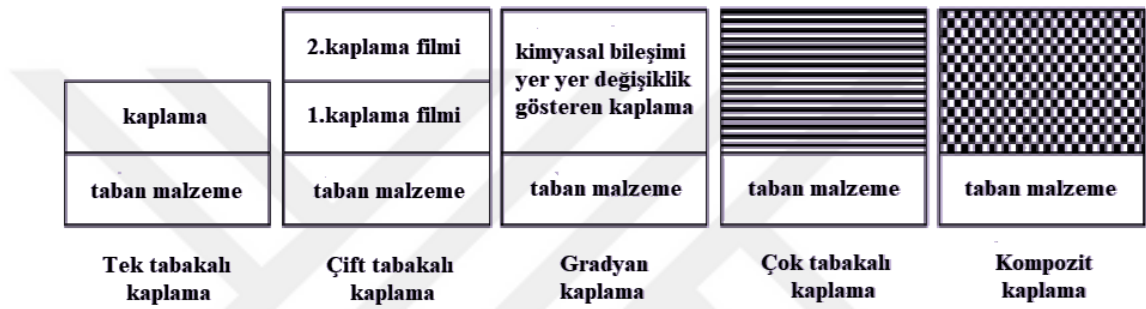
Şekil 2.11. Farklı amaçlara göre çeşitlilik gösteren kaplama yapıları (Panjan et al. 2005)
