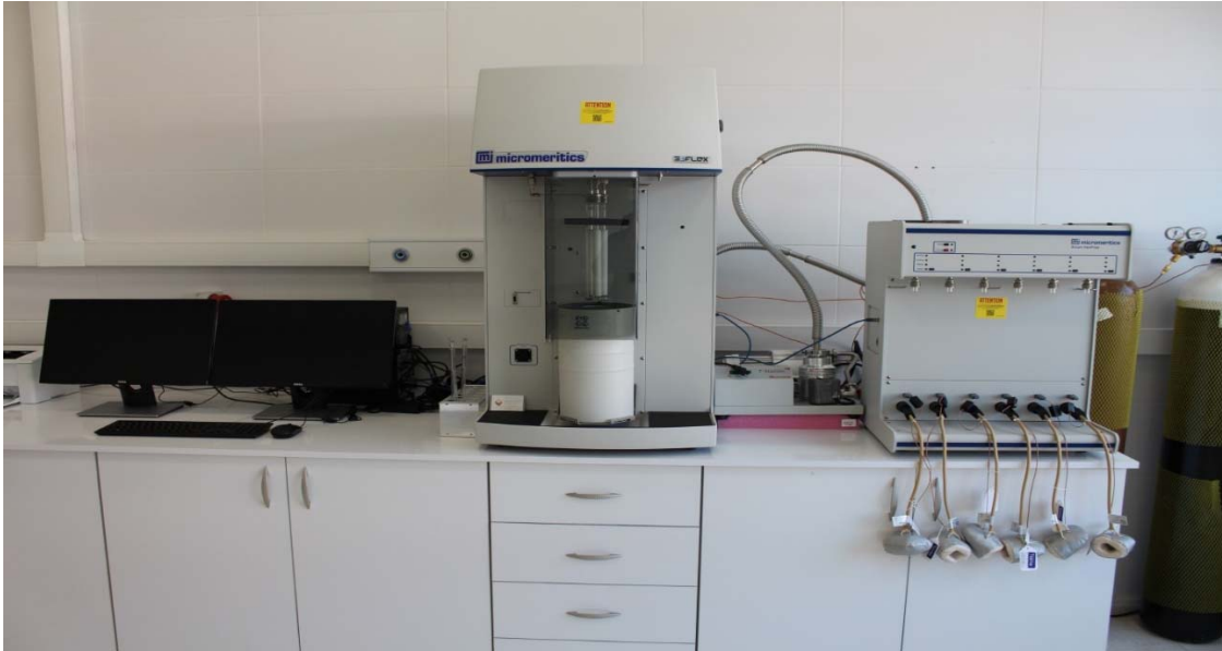
Şekil 11. BET Yüzey alanı ölçüm cihazı
