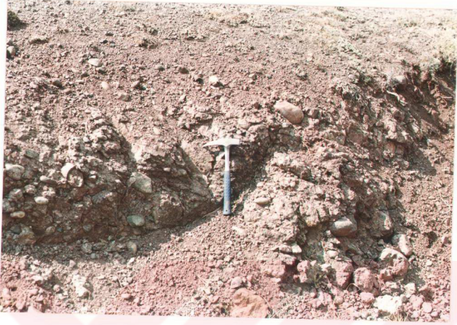
Şekil 2. 21, Ekinlik Sırtı'nda Küllüce Tepe formasyonuna ait kırmızımsı, yeşilimsi ve bordo renkte ofiyolitik çakıllardan oluşan ve çakıl boyutları 1-2 cm'den 25-30 cm'ye kadar değişen konglomeratik seviyeden bir görünüm.
