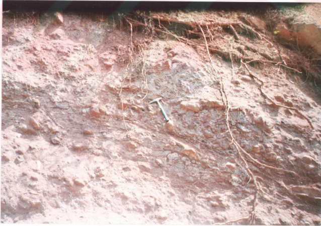
Şekil 2. 22, İyi yuvarlaklaşmış, iyi çimentolanmış fakat tabakalanması iyi olmayan Küllüce Tepe formasyonunun Ekinlik Sırtı'ndan görünüşü.
