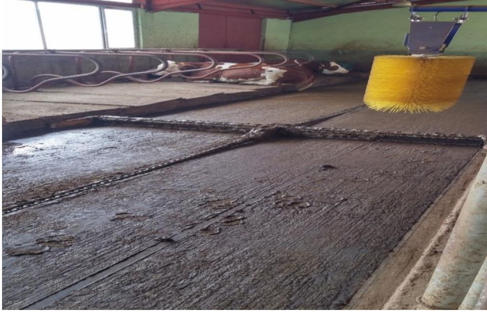
Şekil 4.4. Bir ahırdaki zincirli sıyırıcı
