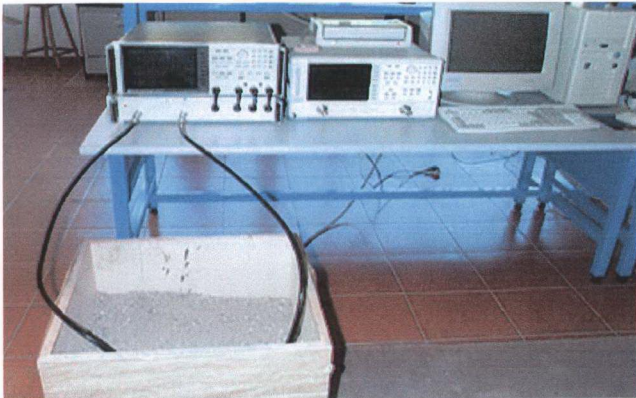
Şekil 5.2. Prob tekniği ile dielektrik sabiti ölçüm düzeneği.
