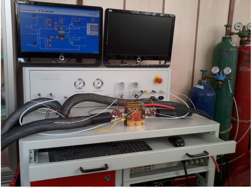
Şekil 3.18. Deneylerde kullanılan yakıt pili test istasyonu ve otomasyon sistemi
