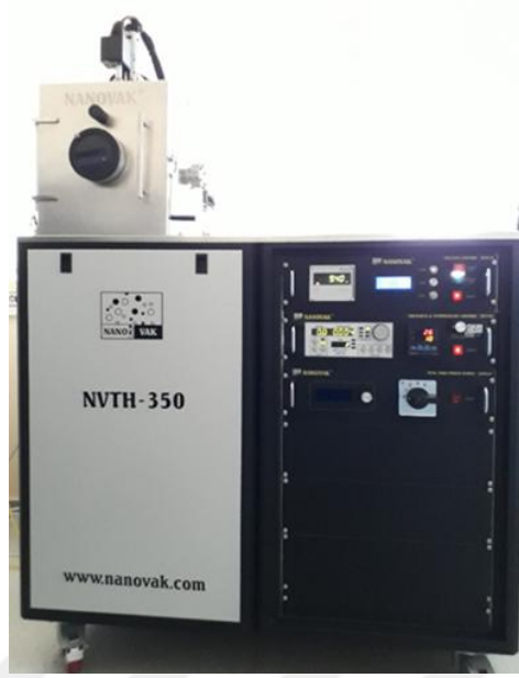
Şekil 3.1. Omik ve Schottky kontak yapımında kullanılan termal buharlaştırma sistemi
