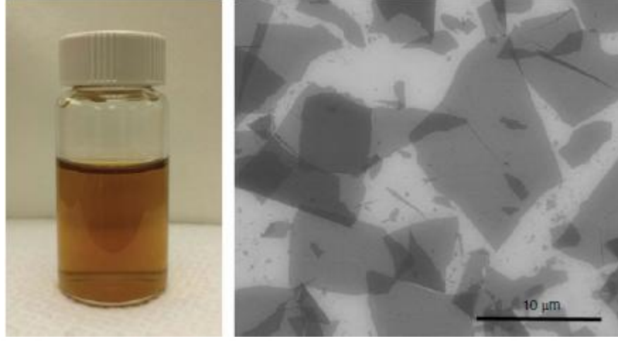
Şekil 2.13. Çözelti halindeki GO ve bir substrat yüzeyinden alınan GO'nun SEM görüntüleri (Dimiev and Eigler 2016).
