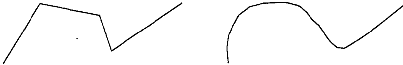
Şekil 6.1 Bir Çizim ve Bu Çizimin Eğri Uydurma Yöntemiyle Elde Edilmiş B-Spline Hali
