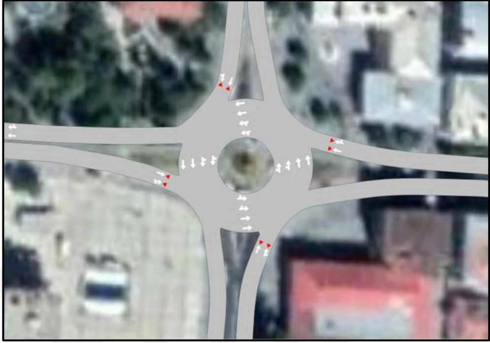
Şekil 4.30. Dört yol kavşağı modern dönel kavşak uygulaması
