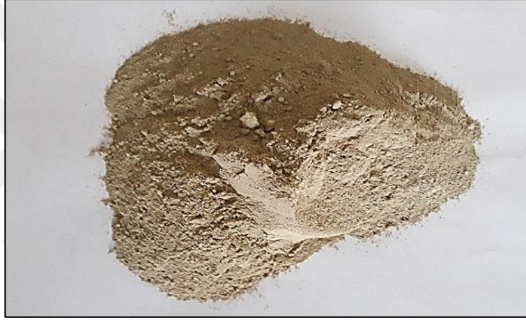
Şekil 3.4. 40 nolu elekten elenen doğal kil
