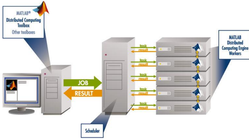
Şekil 3.1 MATLAB Dağıtık hesaplama yönteminin işleyiş şeması
