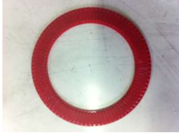
Şekil 3.25 G otomatik tip filtrenin diski
