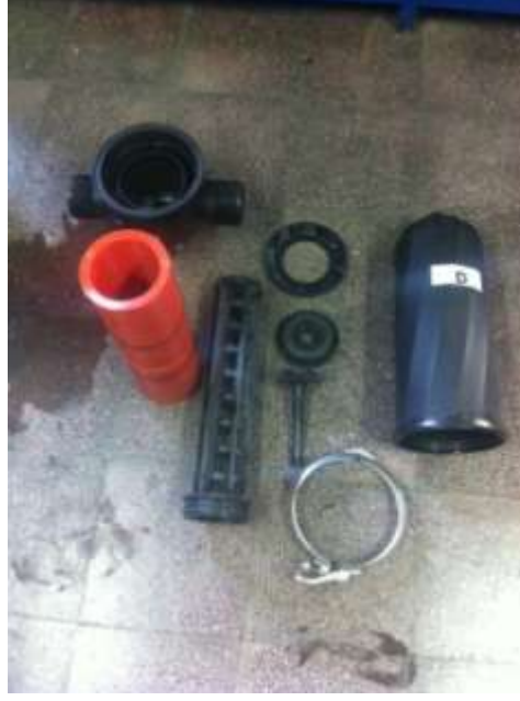
Şekil 3.18 D manuel tip filtrenin demontaj hali
