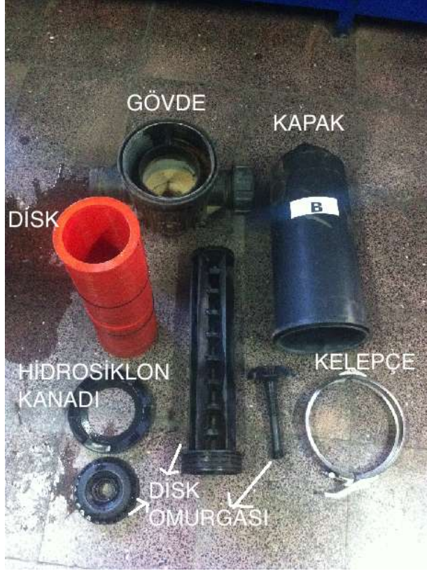
Şekil 3.8 Manuel plastik disk filtre parçaları
