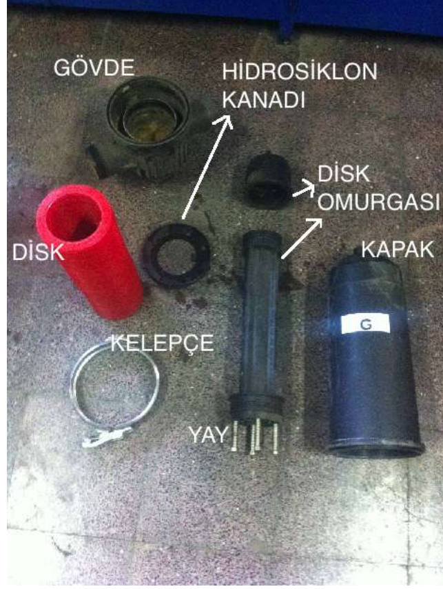
Şekil 3.9 Otomatik plastik disk filtre parçaları
