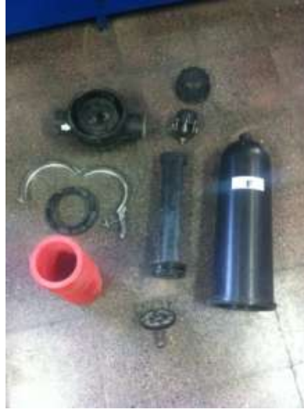
Şekil 3.22 F otomatik tip filtrenin demontaj hali
