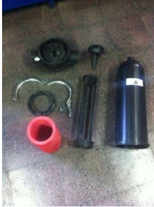
Şekil 3.12 A manuel tip filtrenin demontaj hali
