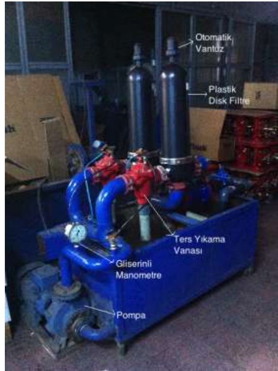
Şekil 3.3 Laboratuvar deney düzeneği fotoğrafı
