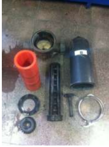
Şekil 3.14 B manuel tip filtrenin demontaj hali
