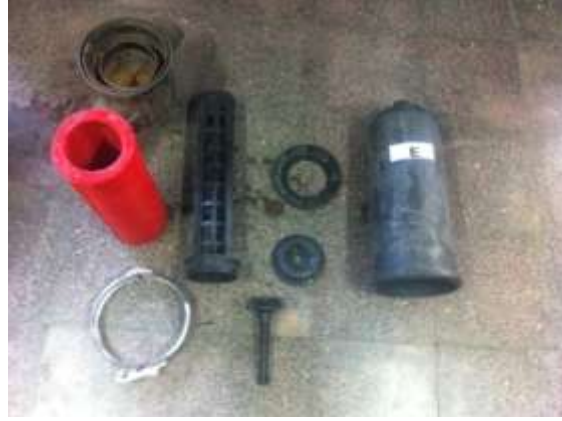
Şekil 3.20 E manuel tip filtrenin demontaj halı
