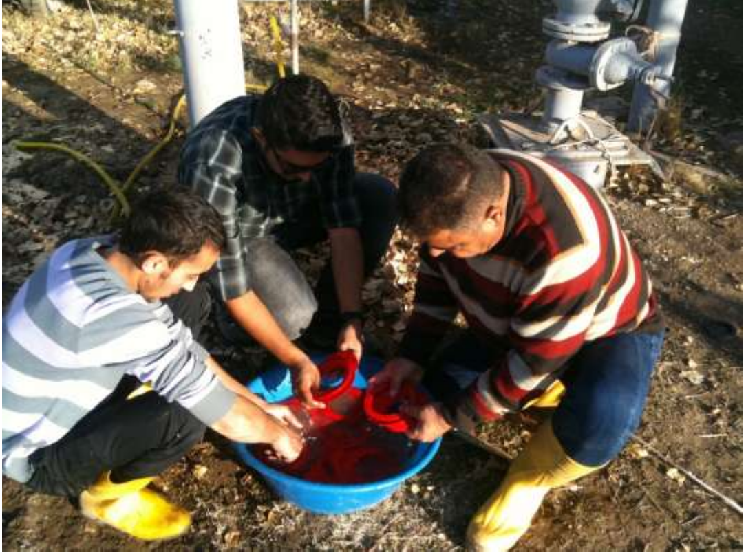
Şekil 3.38 Disklerdeki kumların su yardımıyla kaba aktarılması
