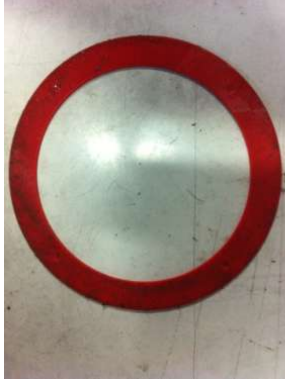
Şekil 3.17 C manuel tip filtrenin diski
