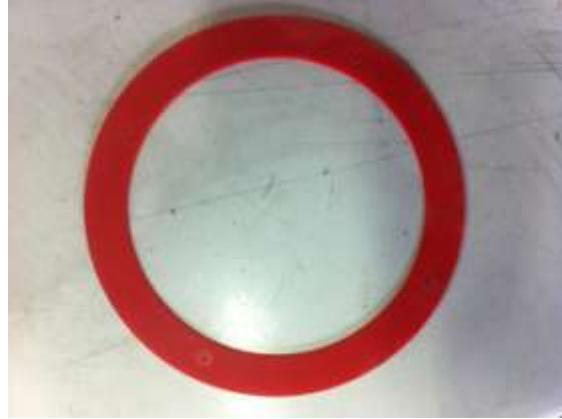
Şekil 3.19 D manuel tip filtrenin diski
