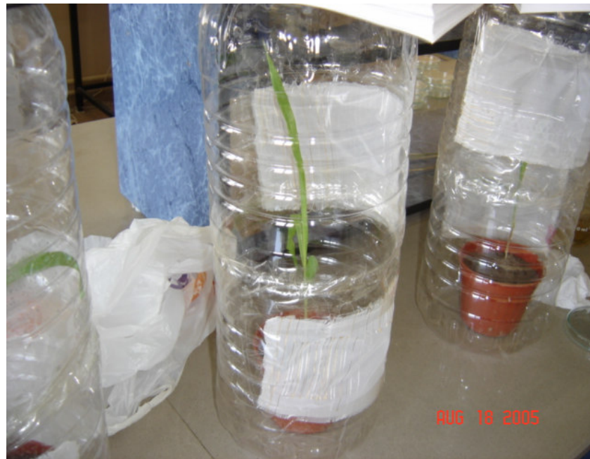
Şekil 3.2. Parazitot çıkışının gözlenmesi amacıyla kullanılan pet şişeden yapılmış kültür kapları
