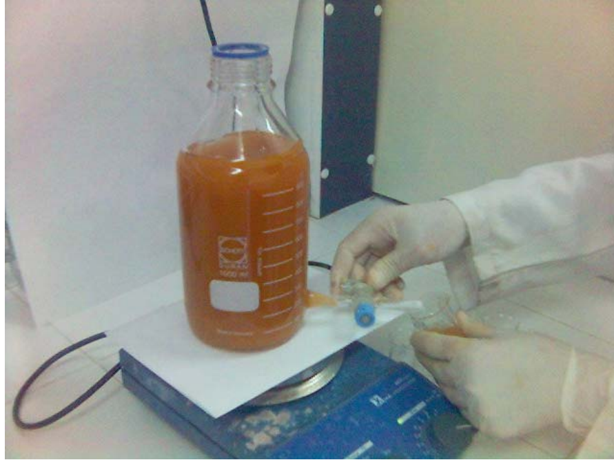
Şekil 3.4. Kinetik çalışmada kullanılan musluklu Schott şişesi
