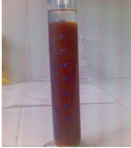
Şekil 3.6. Kolonda çamur çökelme işlemi
