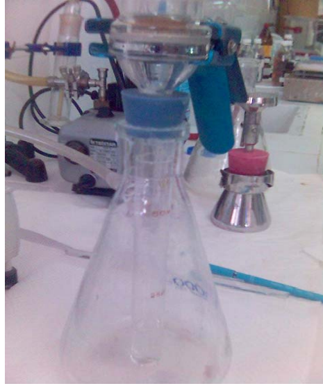
Şekil 3.7. Çalışmada kullanılan vakum filtre düzeneği
