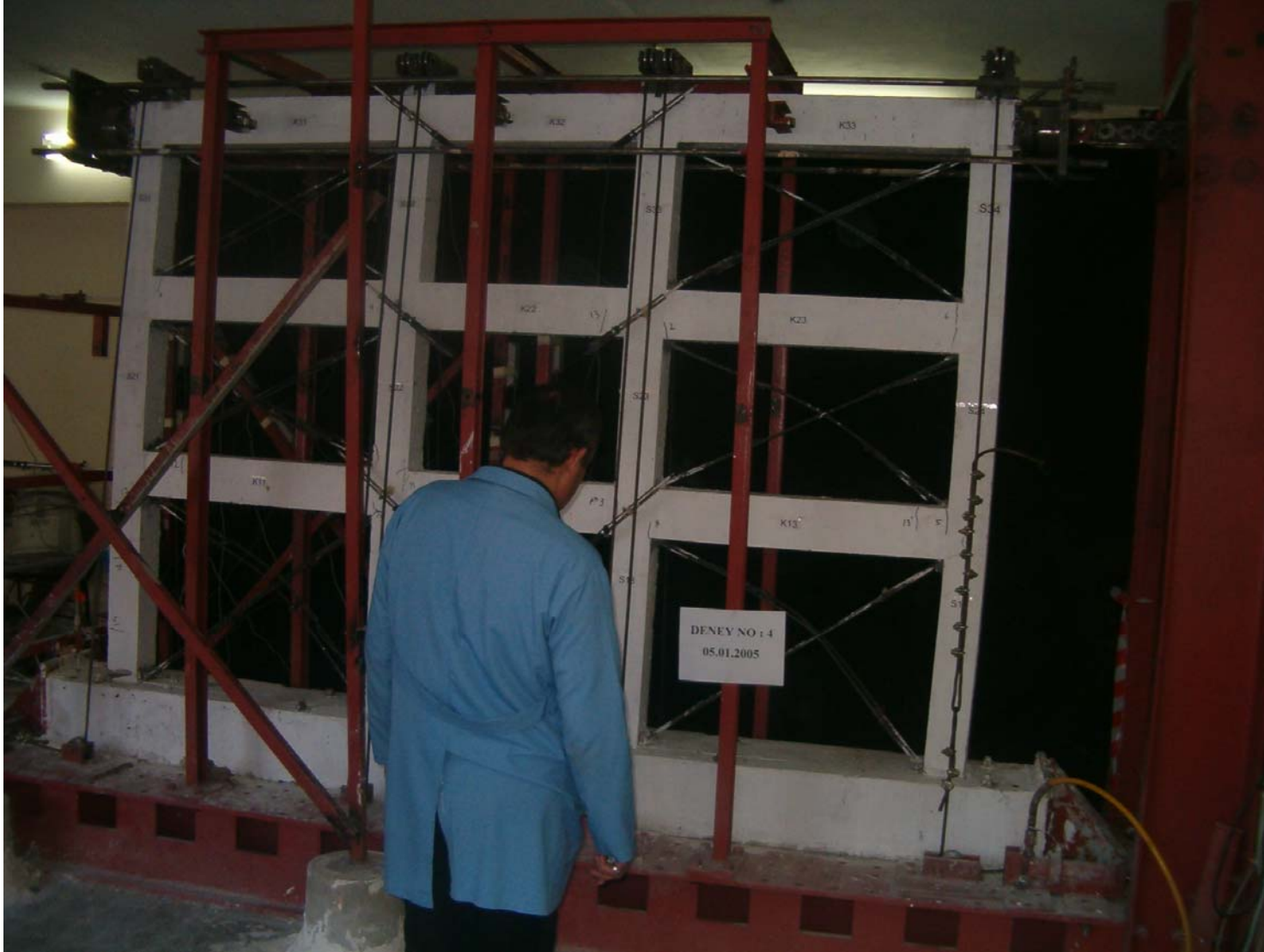
Şekil 5.4.2 4 nolu deney sırasında oluşan çatlaklar
