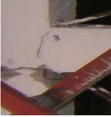
Şekil 5.6.4 Deney sonunda birleşim bölgesinde etriye olmasından ötürü parçalanmamış kenar kolon kiriş birleşim bölgesi
