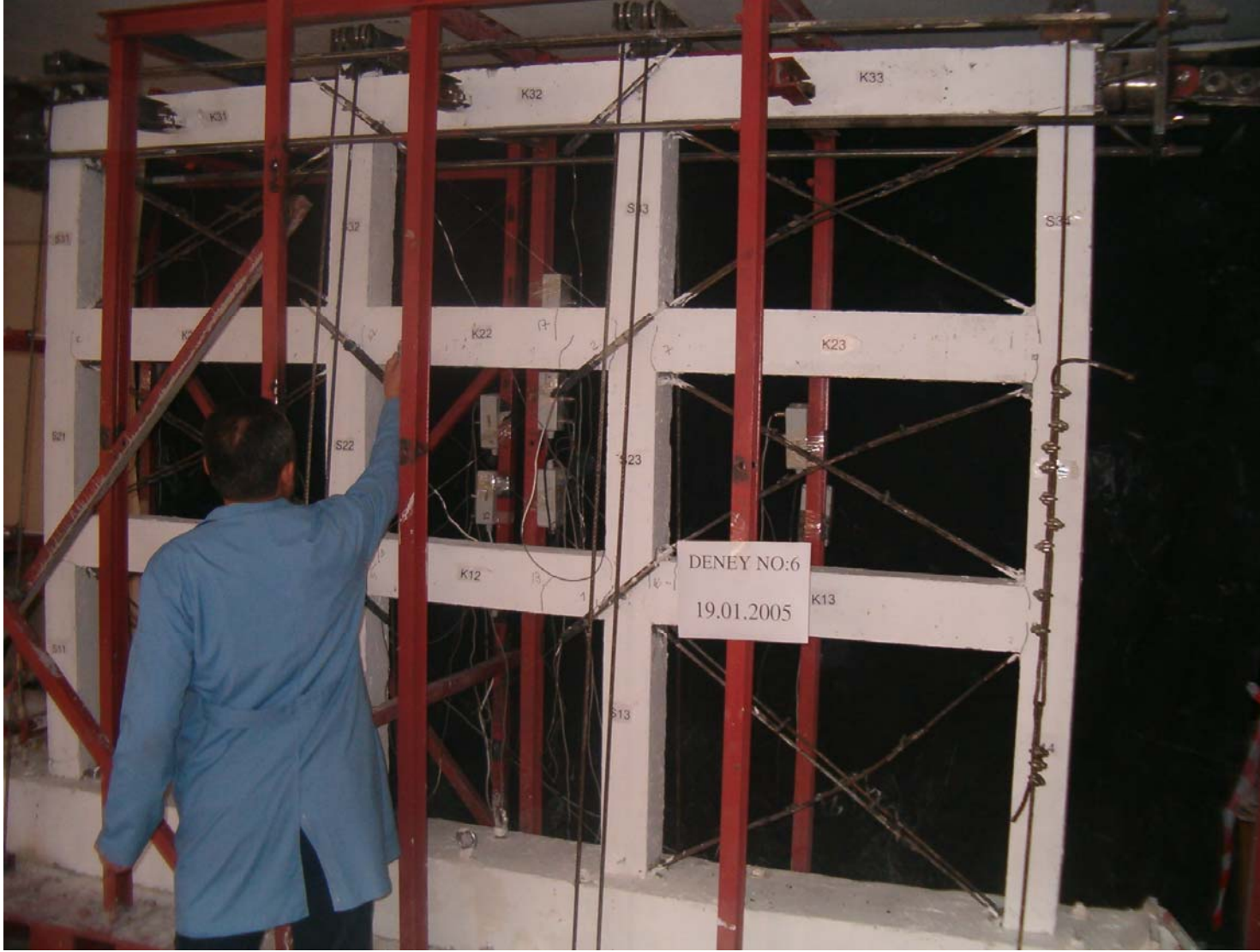
Şekil 5.6.2 6 nolu deney sırasında oluşan çatlaklar
