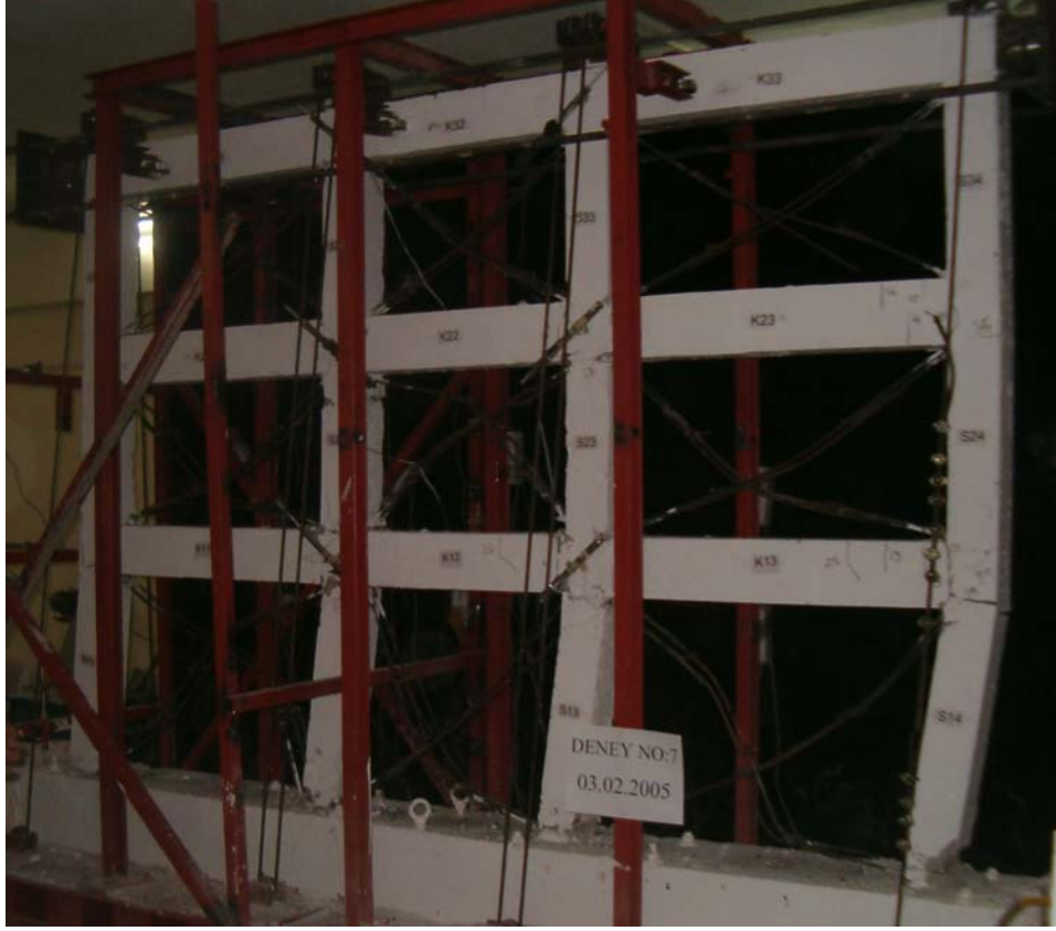
Şekil 5.7.9 7 nolu deney numunesinde yumuşak kat mekanizması
