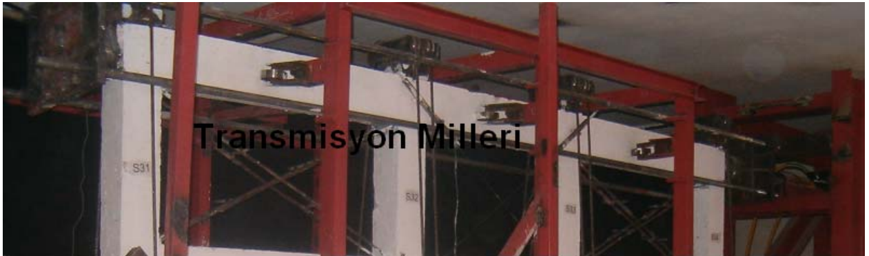
Şekil 3.15 Tersinir yüklemeyi sağlayan transmisyon milleri ve arka başlık
