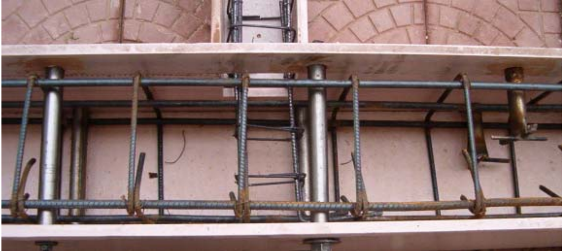
Şekil 3.29 Numune temelini yüklemeye çerçevesine sabitlenmesini sağlayan tij boruları
