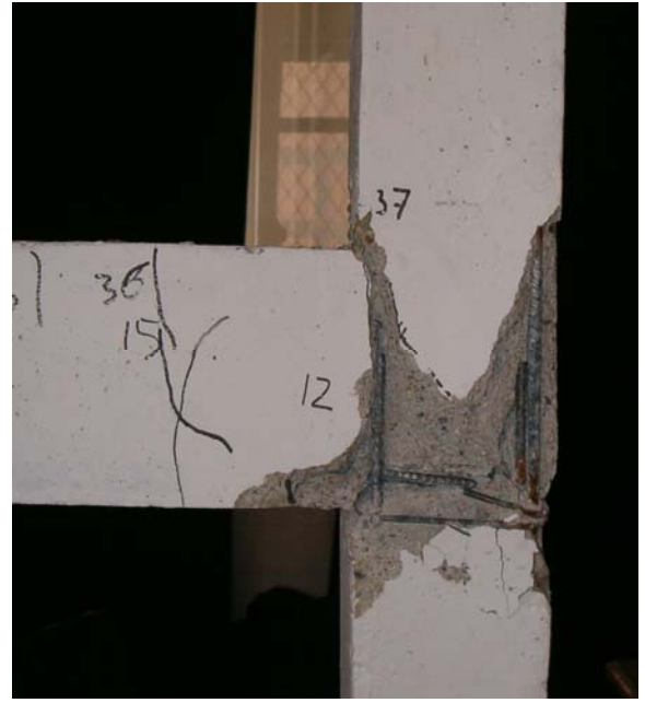
Şekil 5.2.9. 2 nolu deney numunesi S11 ve S14 kenar kolon kiriş birleşimleri
