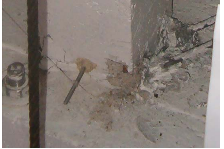
Şekil 5.4.9 4 nolu deney numunesi orta kolon alt ucunda ezilme ve çapraz sıyrılması
