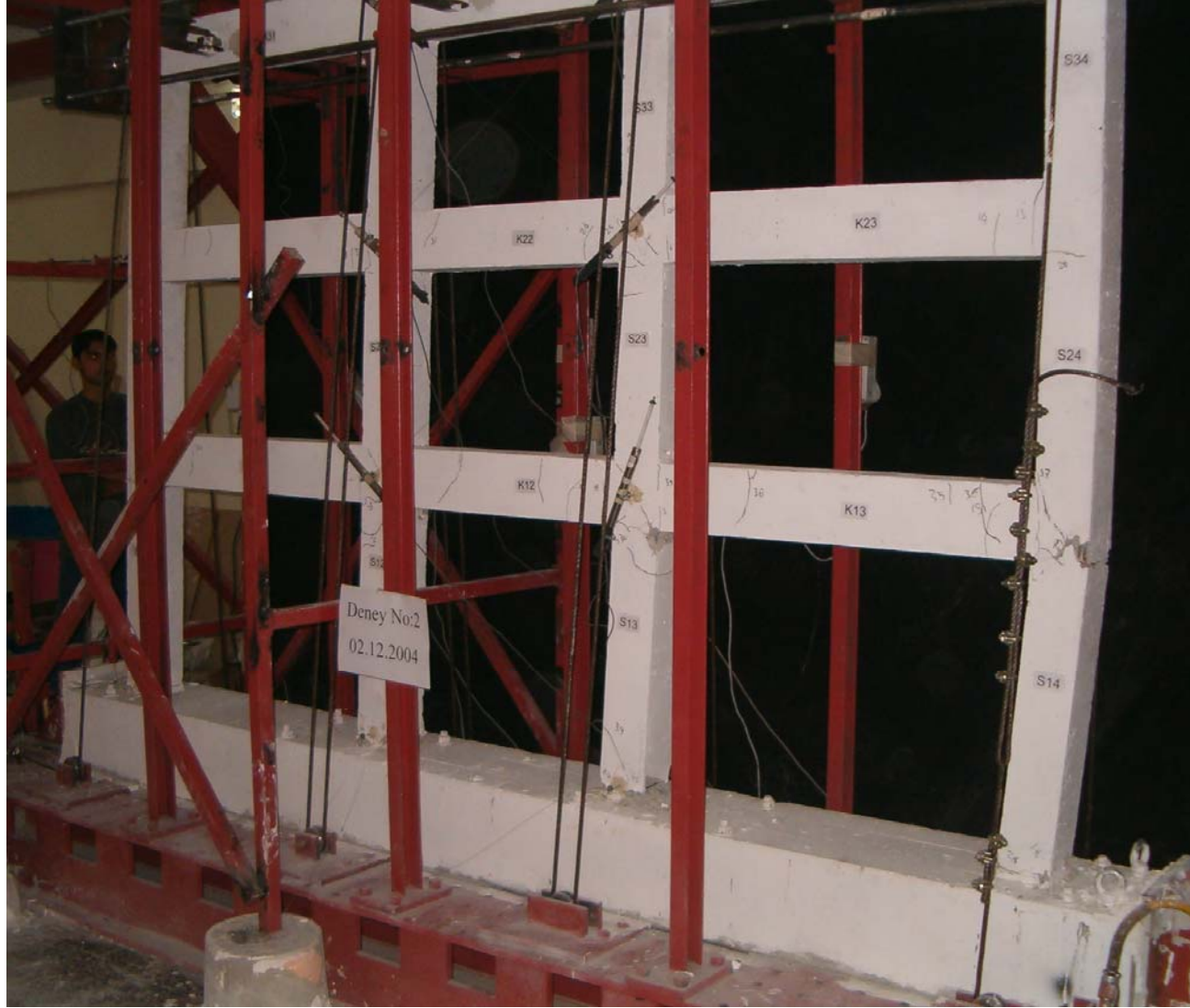
Şekil 5.2.2 2 nolu deney sırasında oluşan çatlaklar
