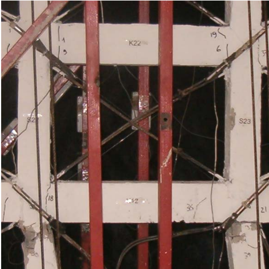
Şekil 5.8.5 8 nolu deney numunesinin orta kolon kiriş birleşimleri
