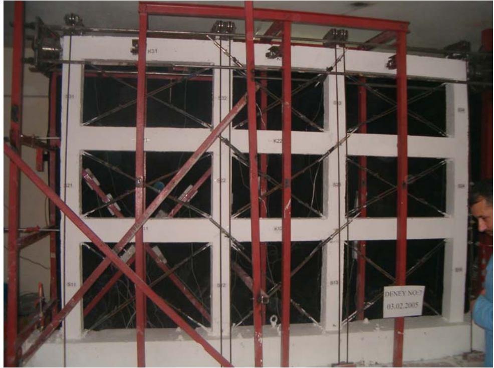
5.7.1 Şekil 07DT1C12TKHD numunesinin deney öncesi görünümü
