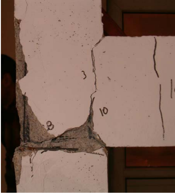
Şekil 5.2.9. 2 nolu deney numunesi S11 ve S14 kenar kolon kiriş birleşimleri
