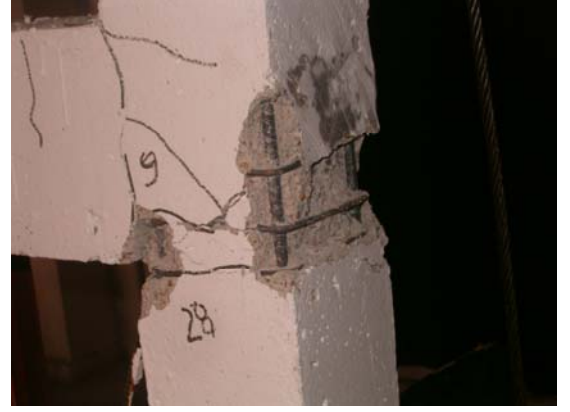
Şekil 5.6.4 Deney sonunda birleşim bölgesinde etriye olmasından ötürü parçalanmamış kenar kolon kiriş birleşim bölgesi
