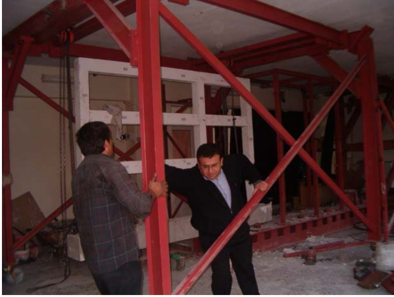
Şekil 3.36 Deney numunelerinin taşınması için imal edilen vinç
