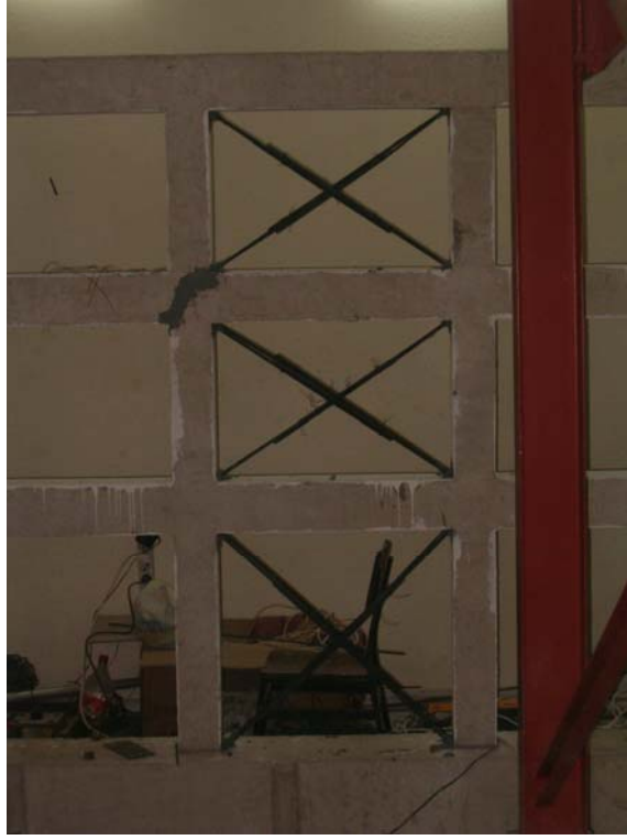
Şekil 3.45 Çaprazlar çubukların kaynaklanması
