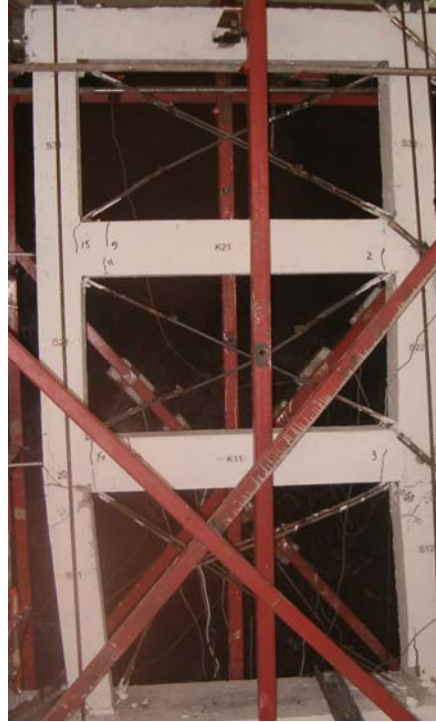
Şekil 5.8.10 8 nolu deney numunesinde çekmeye çalışan ve burkulan kuşaklamalar
