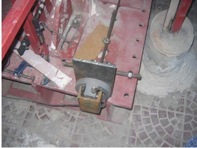
Şekil 4.2. Deneylerde kullanılan düşey yük ölçüm düzeneği
