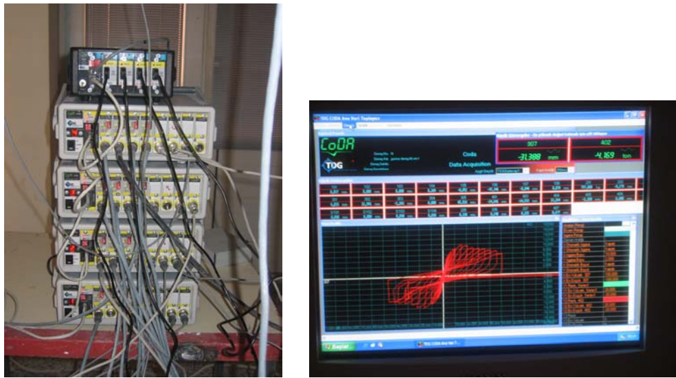
Şekil 4.4. Yük ve yer değiştirme okumalarını değerlendiren veri aktarım sistemi ve bilgisayar düzeneği
