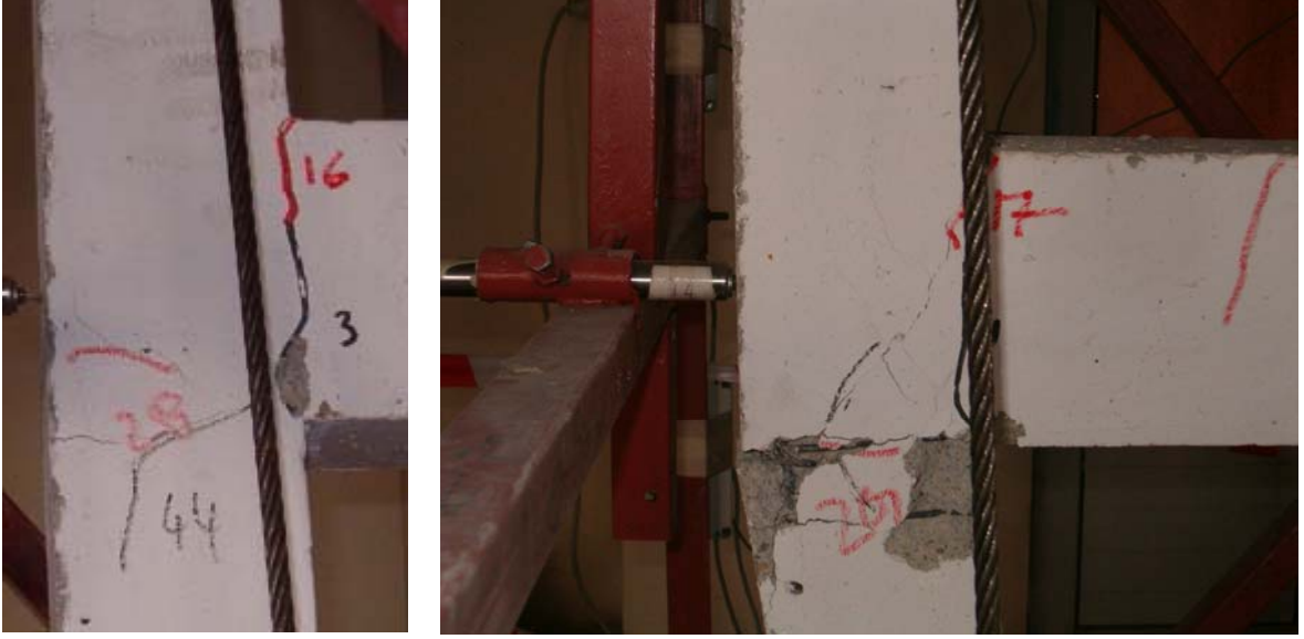
Şekil 5.1.8. 1 nolu deney numunesi 2.kat S21 kolonunun üst ve alt düğümleri
