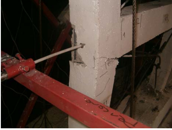
Şekil 5.4.4 Deney sonunda etriye olmamasına rağmen parçalanmamış kenar kolon kiriş birleşim bölgesi
