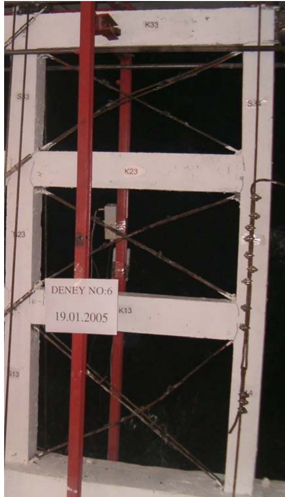
Şekil 5.6.10 6 nolu deney numunesinde çekmeye çalışan ve burkulan kuşaklamalar
