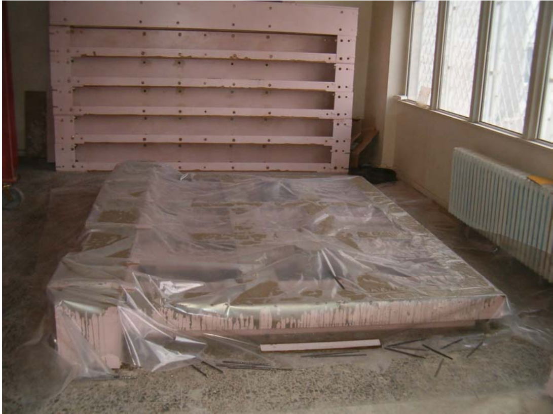
Şekil 3.34 İçeride üretilen numunelerin kürlenme işlemi
