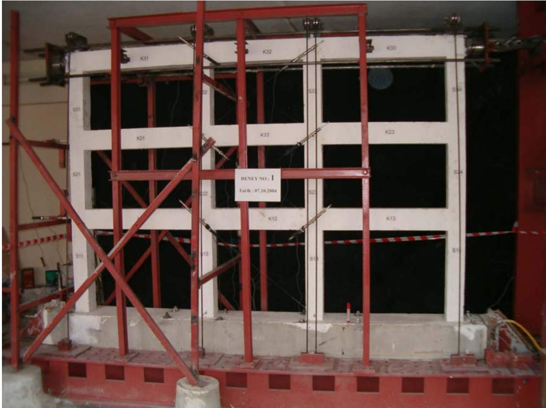
Şekil 4.5. Deney numuneleri için deneylerde kullanılan ölçüm düzenegi
