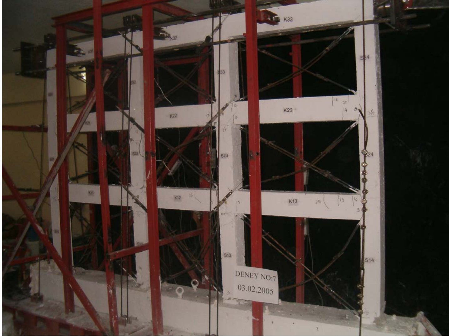
Şekil 5.7.2 7 nolu deney sırasında oluşan çatlaklar
