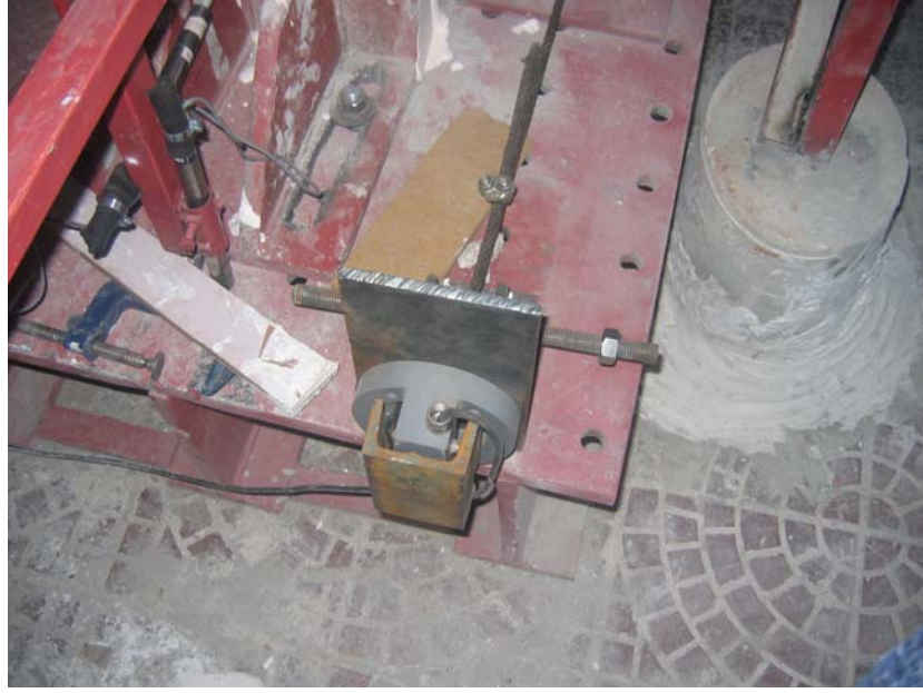
Şekil 3.18 Eksenel yük değerini kullanan bilgisayar programına aktaran loadcell sistemi
