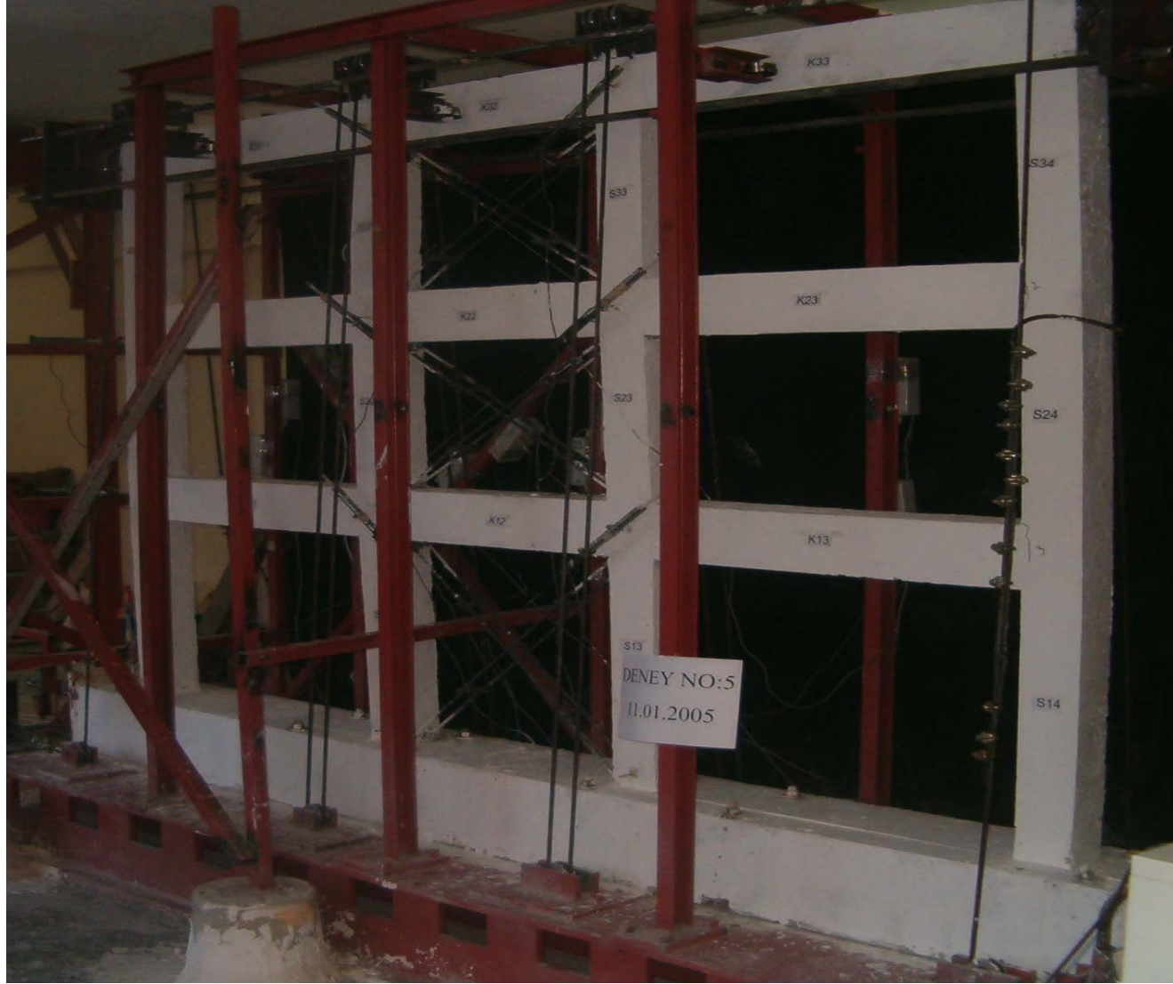
Şekil 5.5.2 5 nolu deney sırasında oluşan çatlaklar
