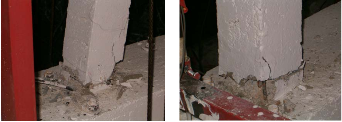
Şekil 5.3.8. 3 nolu deney numunesi orta ve kenar kolon tabanlarında basınç ezilmesi
