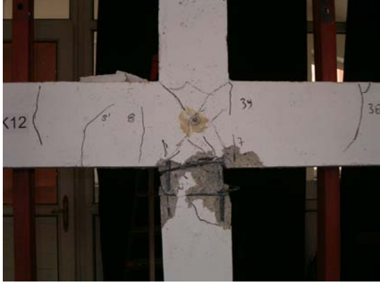
Şekil 5.2.8 2 nolu deney numunesi S12 ve S 13 orta kolon kiriş birleşimleri ve düğümlerde X çatlakları ile çözülmüş etriyeler
