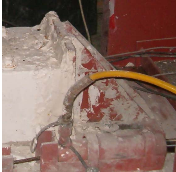
Şekil 3.19 Yatay hareketi engelleyen mahmuzlar
