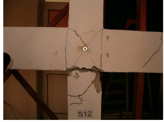
Şekil 5.2.8 2 nolu deney numunesi S12 ve S 13 orta kolon kiriş birleşimleri ve düğümlerde X çatlakları ile çözülmüş etriyeler
