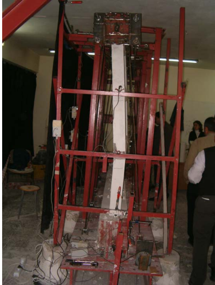
Şekil 5.2.7 2 nolu deney çerçevesinde burkulma
