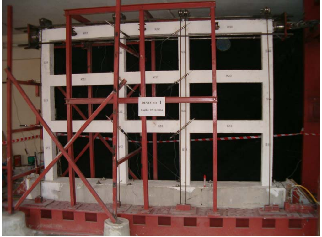
Şekil 5.1.2. 01DT1C20HKHD numunesinin deney öncesi görünümü
