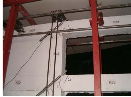
Şekil 3.17 Aksel yük verilmesine imkan sağlayan makara ve kablolardan oluşan sistem
