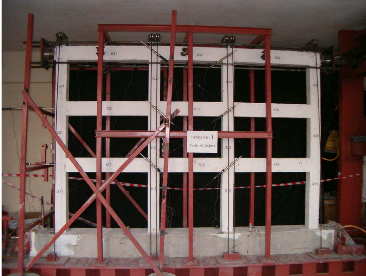
Şekil 5.1.3. Deney numunesinde ilk oluşan çatlaklar
