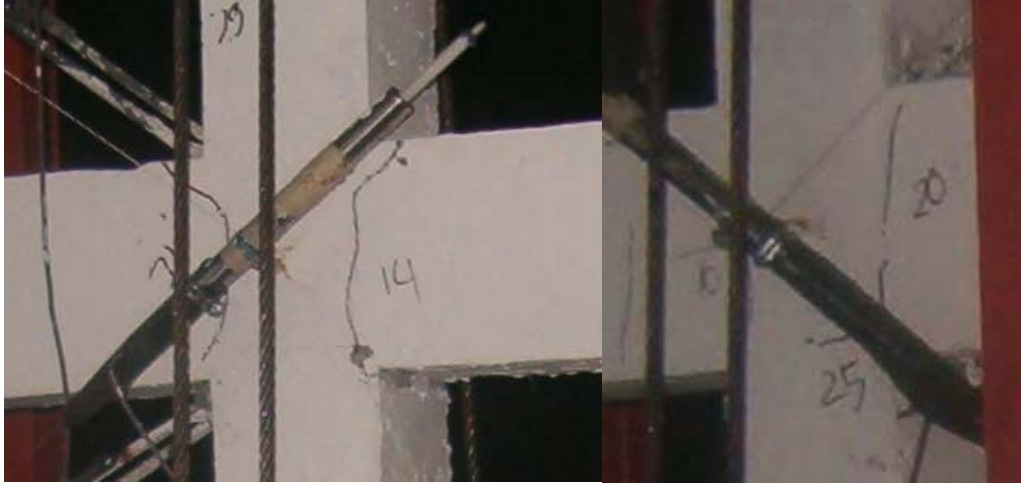
Şekil 5.5.7 5 nolu deney çerçevesi 2.kat orta kolon kiriş birleşimleri
