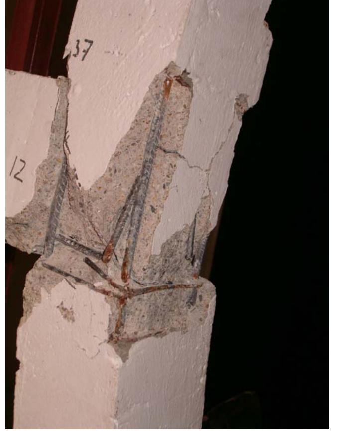
Şekil 5.2.4 Deney sonunda etriye olmamasından ötürü parçalanmış kenar kolon kiriş birleşim bölgesi
