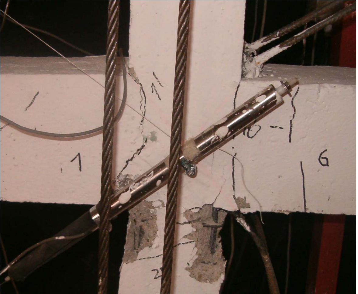
Şekil 5.6.5 6 nolu deney numunesinin orta kolon üstünde mafsallaşma (Çapraz kesme çatlakları oluşmamıştır)
