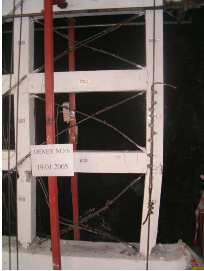
Şekil 5.6.11 6 nolu deney numunesinde alt katta sıyrılmış fakat üst katta çalışmaya devam eden kuşaklamalar
