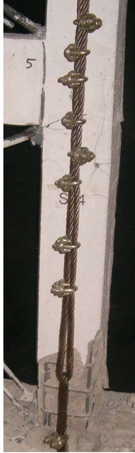
Şekil 5.4.10 4 nolu deney numunesi S11 ve S14 kenar kolonlarında kesme çatlakları
