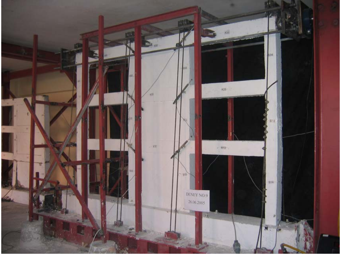
Şekil 4.3. Deneyleerde kullanılan düzenek ve yükleme sistemi
