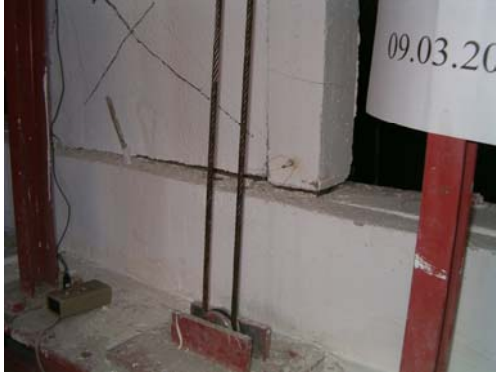
Şekil 3.17 Aksel yük verilmesine imkan sağlayan makara ve kablolardan oluşan sistem
