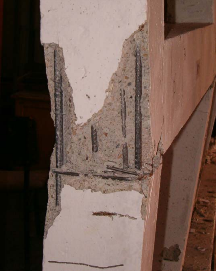
Şekil 5.2.4 Deney sonunda etriye olmamasından ötürü parçalanmış kenar kolon kiriş birleşim bölgesi
