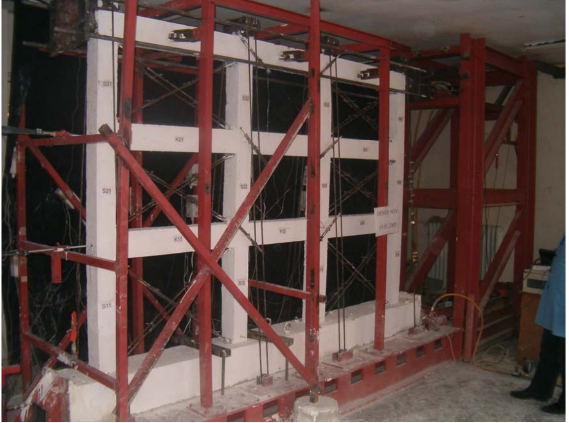
Şekil 3.13 Oluşturulan yükleme çerçevesi
