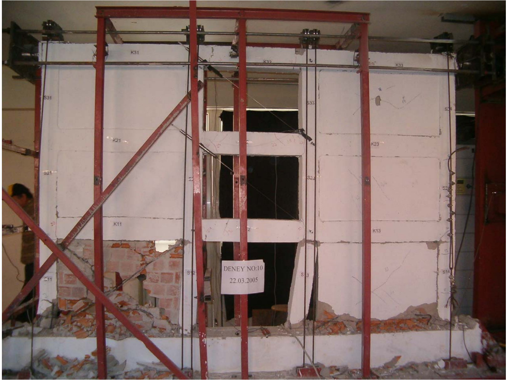
Şekil 5.10.3 Numunenin deney sonundaki görüntüsü
