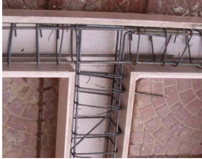
Şekil 3.24 T2 donatı düzenine sahip numunede etriyesiz kolon kiriş birleşim bölgesi
