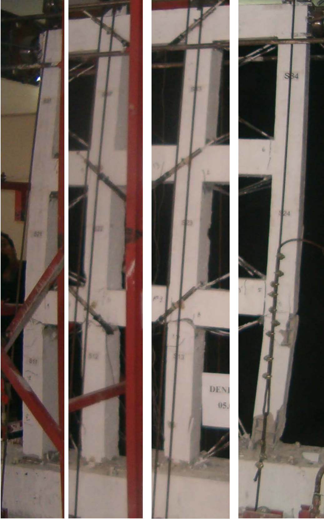
Şekil 5.4.6 Mesnetlerde ve zemin kat kolonlarında oluşan mafsallar
