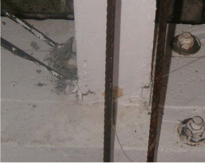
Şekil 5.4.9 4 nolu deney numunesi orta kolon alt ucunda ezilme ve çapraz sıyrılması
