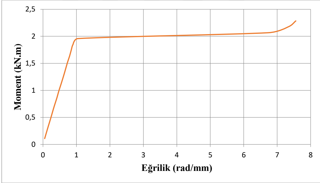
Şekil 101. 1000°C sıcaklığa maruz kalan eğilme kirişinin moment-eğrilik grafiği
