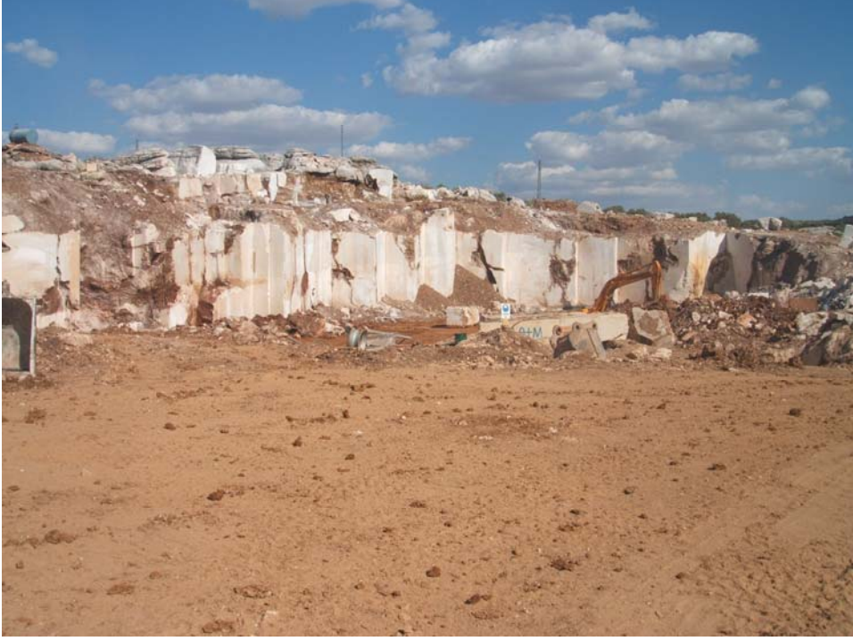
Şekil 9. ATM Mermer, Dragon Baige Ocağı'nda yapılan üretim faaliyeti, üretim aynası ve üretilmiş bloklar
