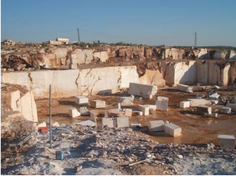
Şekil 11. Tigre Mermer, C Ocağı'nda yapılan üretim faaliyeti, üretim aynası ve üretilmiş bloklar
