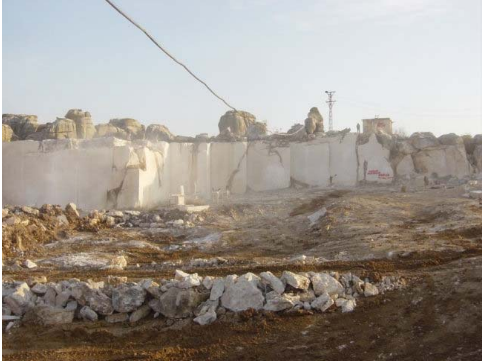
Şekil 15. Dimer Mermer Ocağı'nda yapılan üretim faaliyeti, üretim aynası ve üretilmiş bloklar
