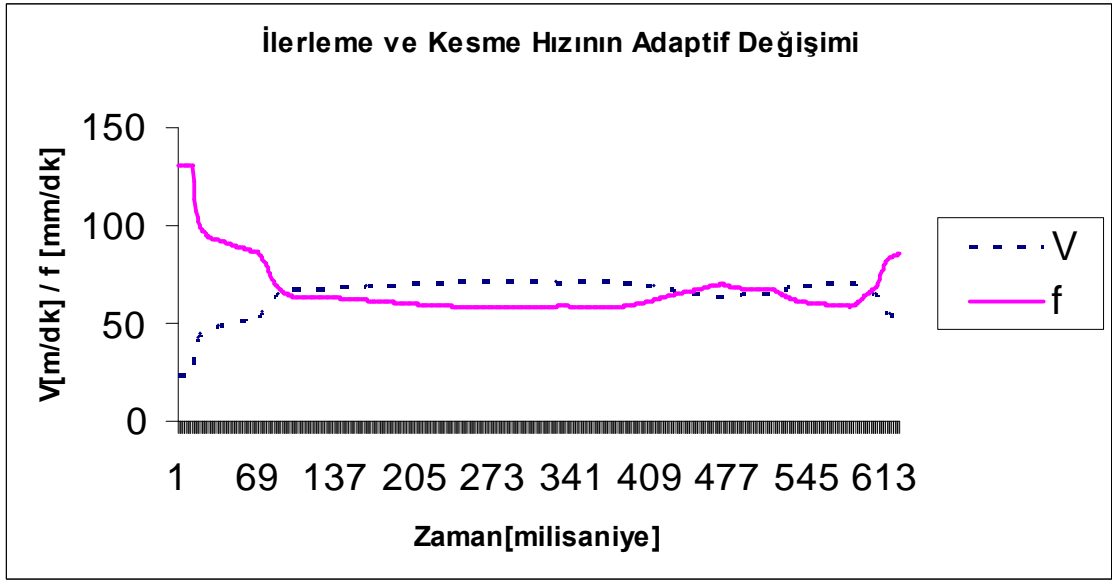
Şekil 8.36. SAE 4140_ \Phi 70mm.Malzemenin ZAKS ile Kesiminde İlerleme ve Kesme Hızı Değişimi.
