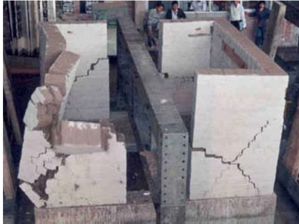
Şekil 3.99 U şeklinde numuneler sarsma tablasında denenirken (Zegarra ve diğ., 2000)
