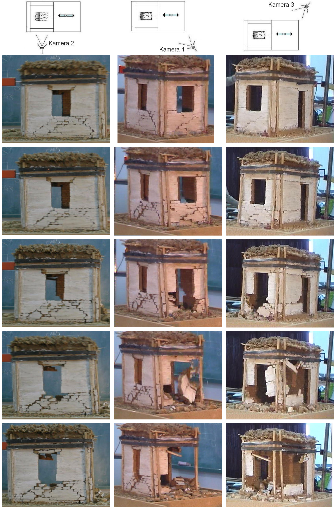
Şekil 4.18 YSN1 numunesinin hasar ve göçme sırası
