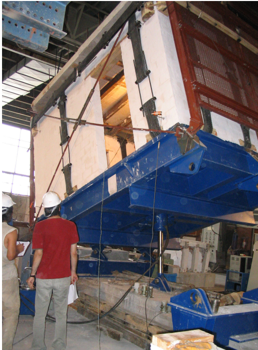
Şekil 4.41 Yatay ve düşey sargılanmış numunenin deney anı
