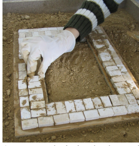
a) Toprak içinde kakac temel için hazırlanan 50 mm eninde duvar
