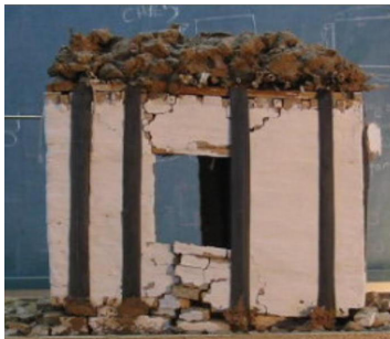
Şekil 4.22 DSN numunesinin hasar ve göçme sırası
