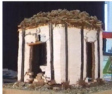
Şekil 4.22 DSN numunesinin hasar ve göçme sırası
