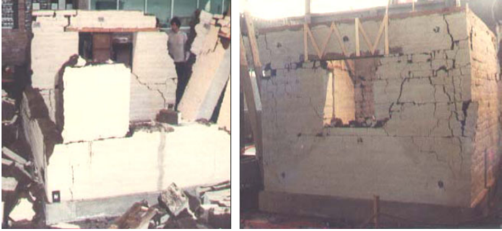
Şekil 3.87 Donatılı ve donatısız numunelerin sarsma masasında denenmesi (Graham, 2001)
