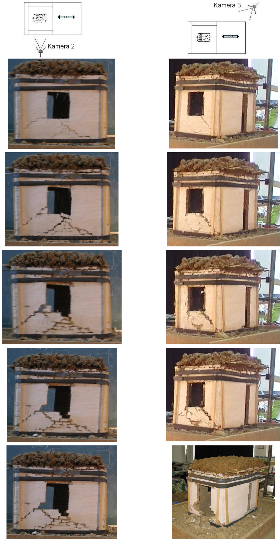
Şekil 4.20 YSN2 numunesinin hasar ve göçme sırası
