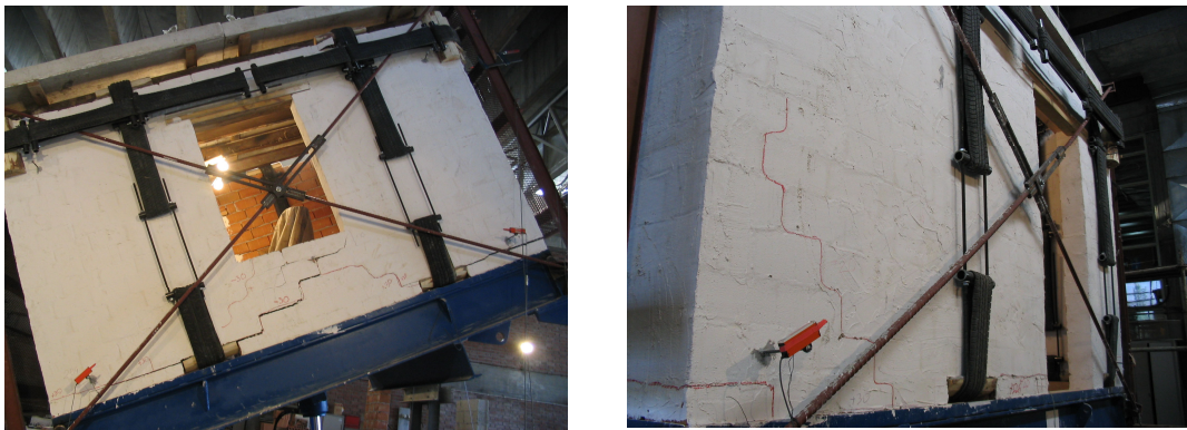
Şekil 4.43 Deney sonunda numunede meydana gelen hasar ve çatlak durumu
