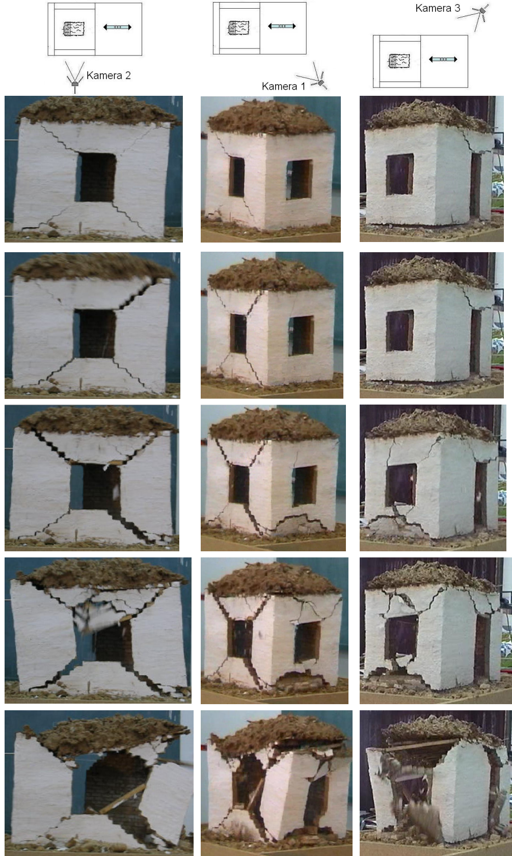
Şekil 4.11 RN2 numunesinin hasar ve göçme sırası
