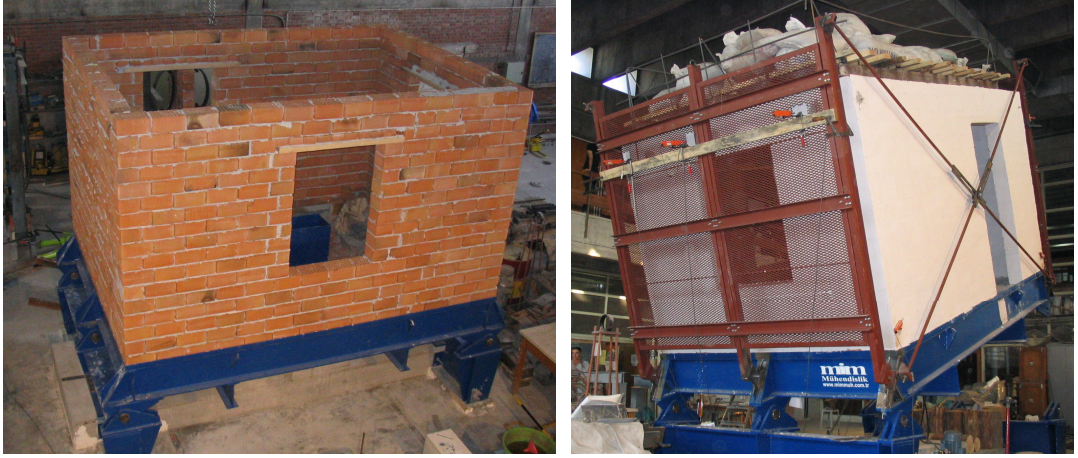
Şekil 4.34 Referans deney numunesinin üretimi ve eğilme tablasında denenmesi
