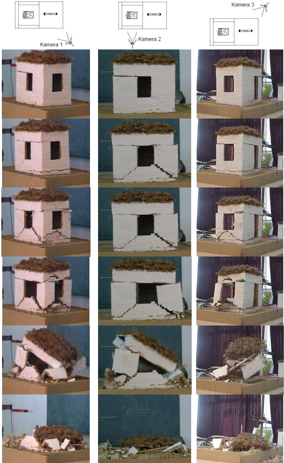
Şekil 4.16 Hatıllı deney numunesinin göçme mekanizması (HN)
