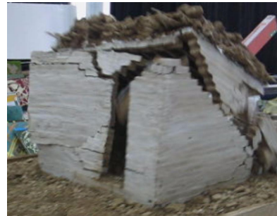
Şekil 4.14 Dik olarak döndürülmüş numunenin göçme mekanizması
