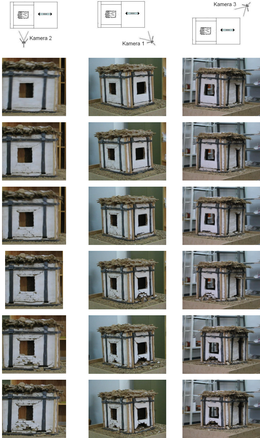
Şekil 4.24 YDSN1 numunesinin hasar ve göçme sırası
