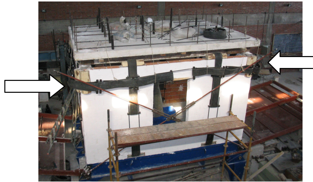
Şekil 4.39 Yatay ve düşey sargılaması yerleştirilmiş numune
