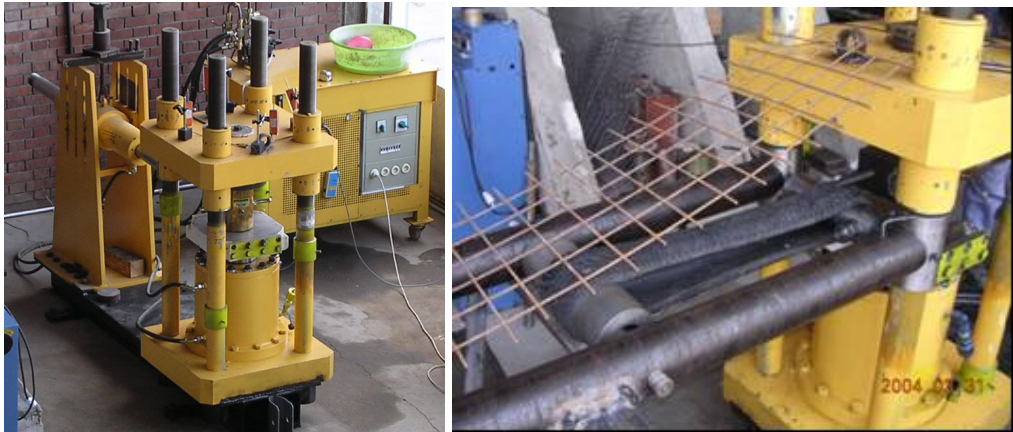
Lastik çekme deneyi ve yükleme düzeneği
