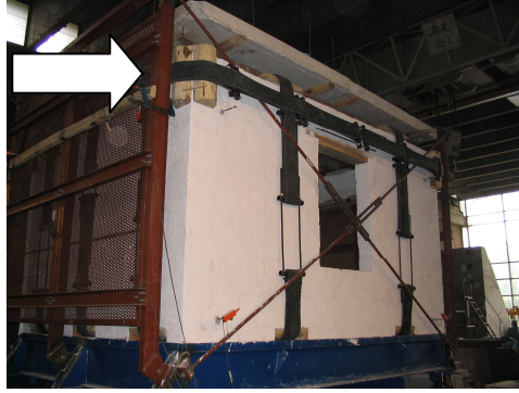
Şekil 4.40 Yatay ve düşey sargılaması gerdirilmiş numune
