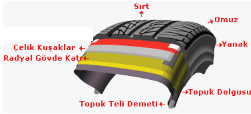
Şekil 4.28 Otomobil lastiğinin en kesiti (DM2003-1451 Proje Raporu, 2003)
