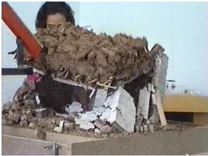
Şekil 4.14 Dik olarak döndürülmüş numunenin göçme mekanizması
