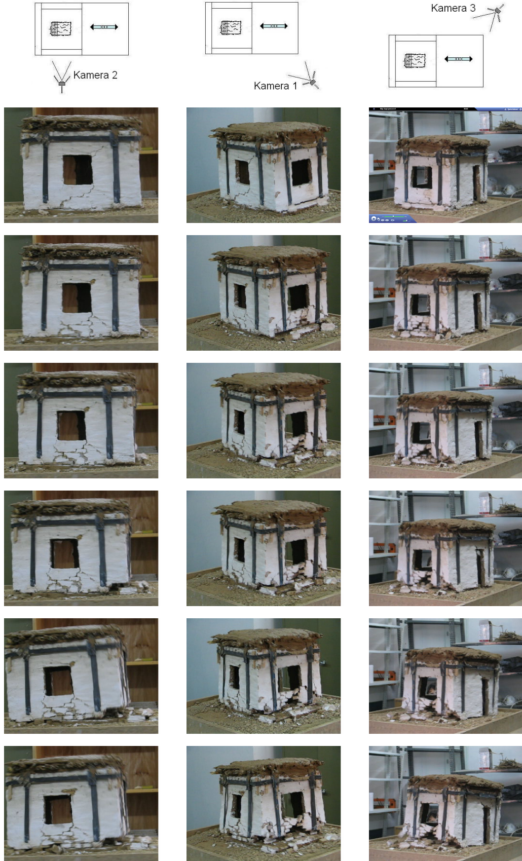
Şekil 4.26 YDSN2 numunesinin hasar ve göçme sırası
