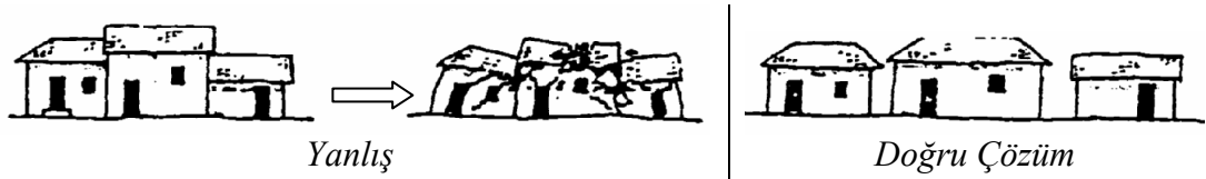
Şekil 3.68 Bitişik nizam binalarda çarpma riski (Weldelibanos, 1993)
