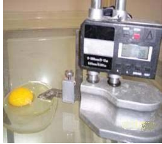
Şekil 3.2 Ak yüksekliğinin yükseklik mihengiri ile ölçülmesi
