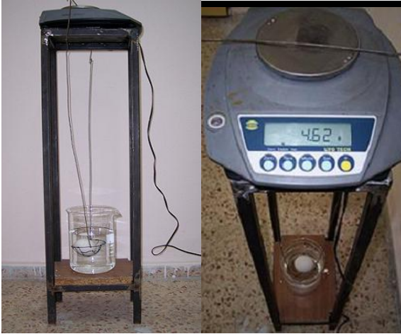
Şekil 3.1 Yumurtanın su içerisinde tartılması
