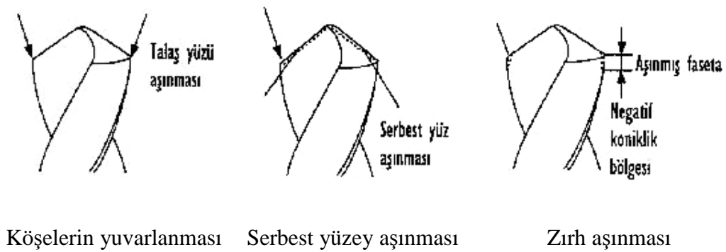
Şekil 3.9 Helisel matkaplarda oluşan aşınma mekanizmaları
