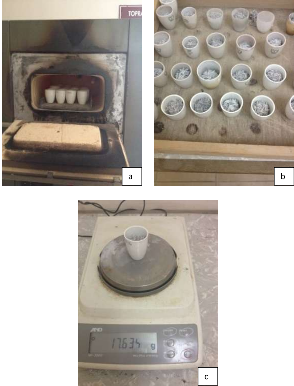
Şekil 3.13. a.b.c Kurutulmuş bitkilerden alınan örneklerin 550°C’lik fırında yakılması ve elde edilen kül miktarının tartımı
