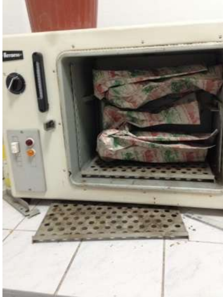
Şekil 3.12 Bitki örneklerinin 70°C lik fırında kurutulması ve kuru ağırlık tartımlarının yapılması işlemleri
