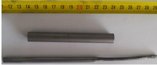
Şekil 5.7 PIT tel hazırlamak için kullanılan demir tüp
