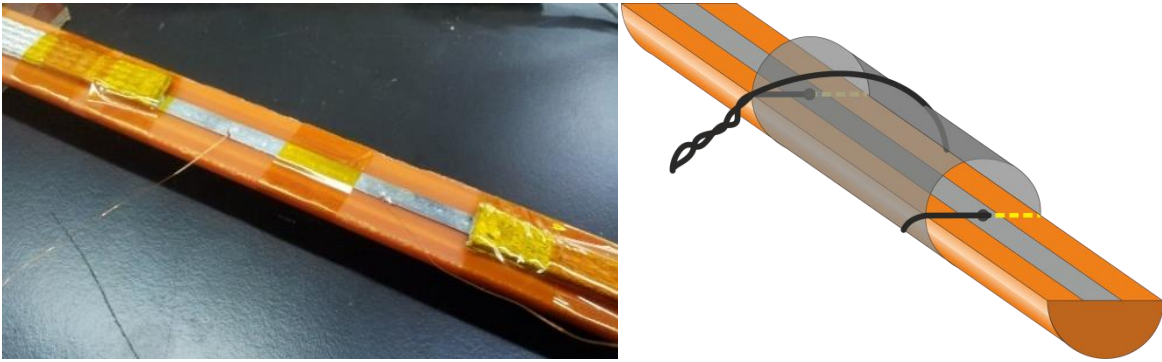
Şekil 5.16 Numune tutucusu ve voltaj kontaklarının hazırlanması
