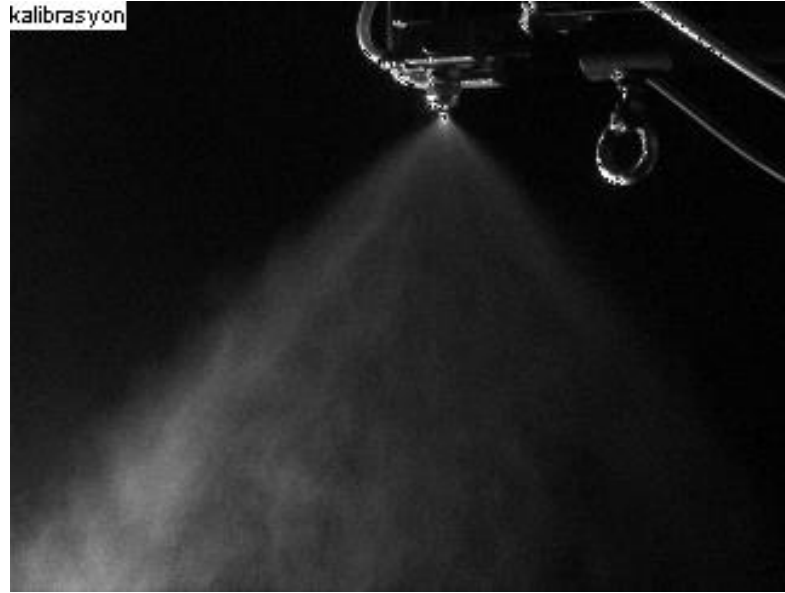
Şekil 74. DXF-HSİ nozulu ALR=0,003875 için sprej görüntüsü. ( Q_h=1,55 \text{ m}^3/\text{h} , Q_s=400 \text{ ml/dk} , P_h=4,5 \text{ Bar} , SMD=74,06 \text{ } \mu\text{m} )
