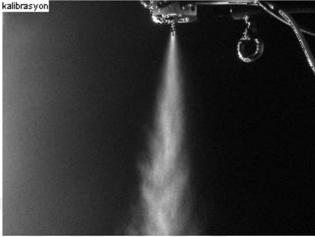
Şekil 63. DXD-HS1 nozulu ALR=0,00675 için spray görüntüsü. ( Q_h=2,7 \text{ m}^3/\text{h} , Q_s=400 \text{ ml/dk} , P_h=3,8 \text{ Bar} , SMD=60,92 \text{ } \mu\text{m} )
