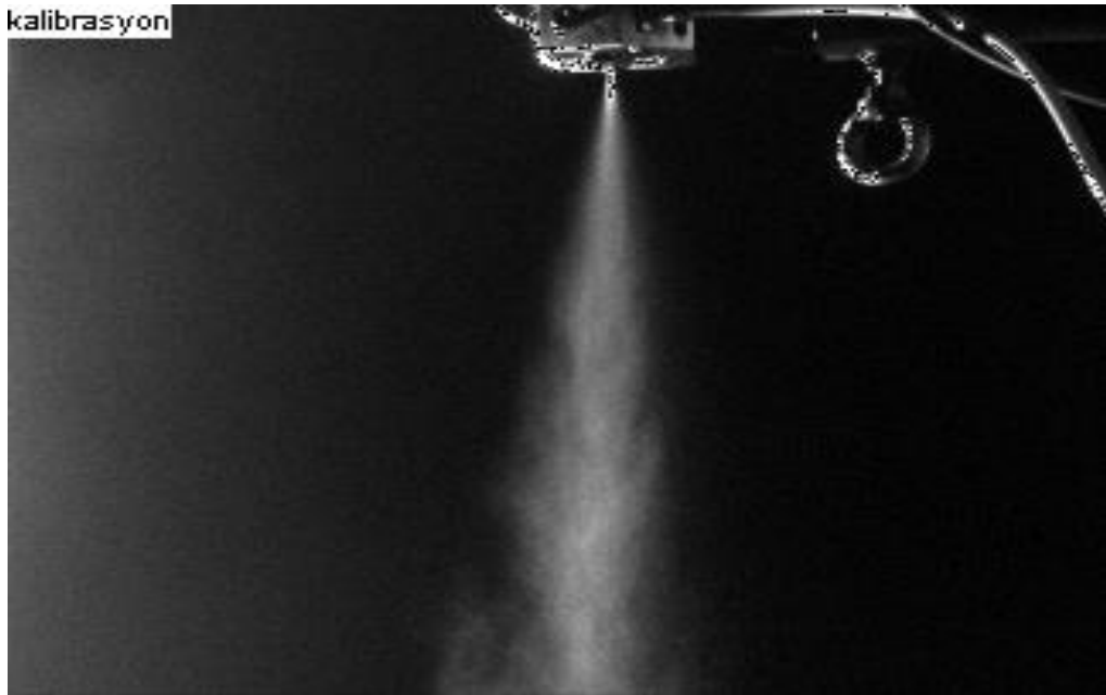
Şekil 62. DXD-HS1 nozulu ALR=0,00675 için spray görüntüsü. ( Q_h=2,8 \text{ m}^3/\text{h} , Q_s=300 \text{ ml/dk} , P_h=4 \text{ Bar} , \text{SMD}=60,52 \text{ }\mu\text{m} )
