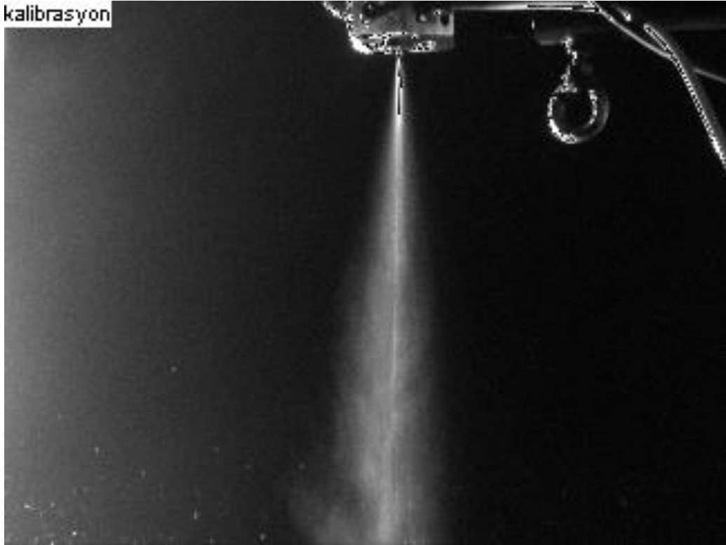
Şekil 64. DXD-HS1 nozulu ile sprayin bozulduğu görüntü.
