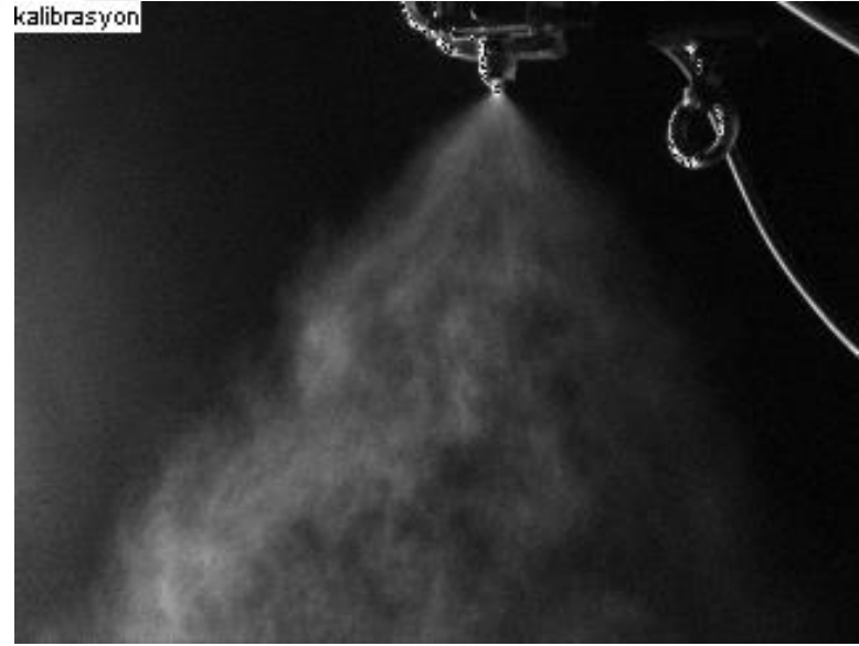
Şekil 73. DXF-HSİ nozulu ALR=0,003875 için spreyle görüntüsü. ( Q_h=1,65 \text{ m}^3/\text{h} , Q_s=300 \text{ ml/dk} , P_h=4,75 \text{ Bar} , SMD=74,56 \mu\text{m} )
