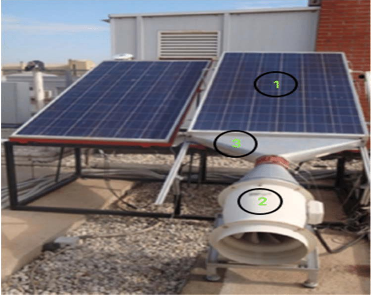
Şekil 21. (PV/T) Zorlanmış hava sirkülasyonu ile soğutulan bir hibrit fotovoltaik / termal sistem (Hernandez 2013).
