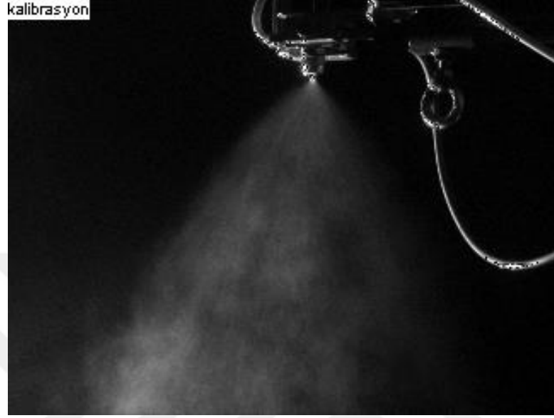
Şekil 72. DXF-HSİ nozulu ALR=0,00875 için spreyle görüntüsü. ( Q_h=1,75 \text{ m}^3/\text{h} , Q_s=200 \text{ ml/dk} , P_h=5 \text{ Bar} , SMD=75,08 \mu\text{m} )
