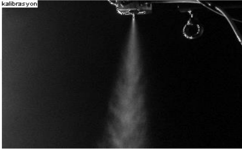
Şekil 61. DXD-HS1 nozulu ALR=0,0145 için spray görüntüsü. ( Q_h=2,9 \text{ m}^3/\text{h} , Q_s=200 \text{ ml/dk} , P_h=4,2 \text{ Bar} , \text{SMD}=60,13 \text{ }\mu\text{m} )
