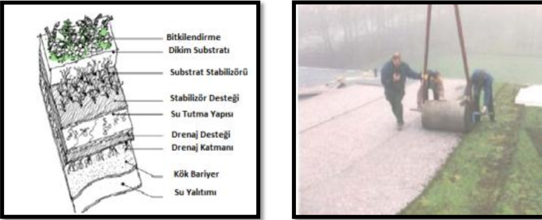
Şekil 4.83 Sistem kurulumunu ve çapraz kesitini gösteren fotoğraf (Anonymous 2012a)
