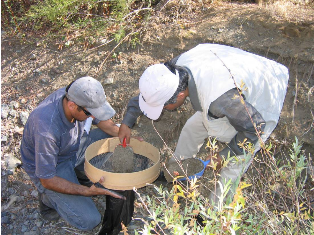
Şekil 1.4. Arazide plaser numune derlenmesi ve 0.5 cm aralıklı elekten geçirilerek tane boyunun ayırılması.
