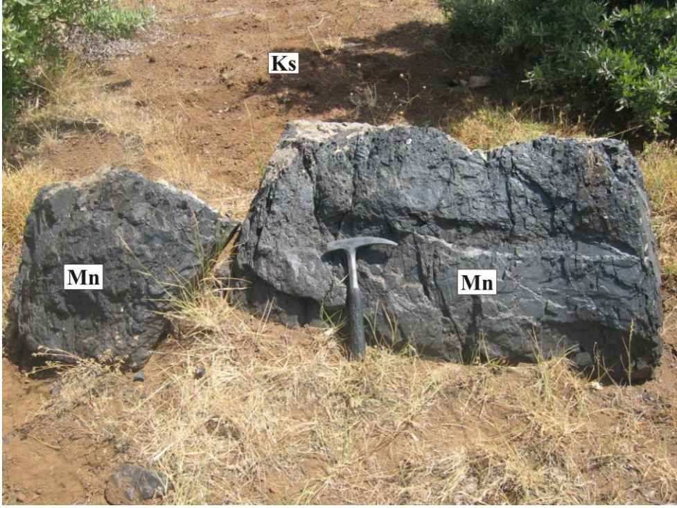
Şekil 3.6. Tavşandeliği Tepe ile Eyrik Tepe arasında dar bir alanda yüzeyleyen Saytepe formasyonu (Ks) içerisinde oluşmuş ve buradan kopan masif mangan blokları.
