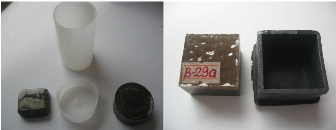
Şekil 1.5. Parlatma kesitleri için kalıp çıkarılabilecek altı kapalı uygun kaplar.
