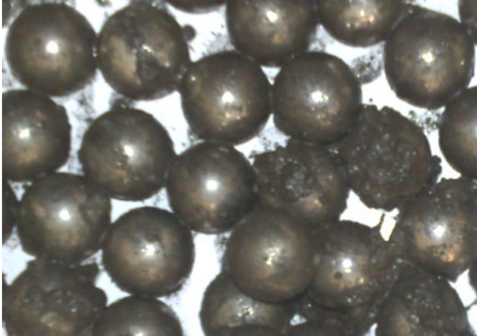
Şekil 8.13. Deney sonrasındaki 8 mm çaplı filtre elemanlarının görünümü
