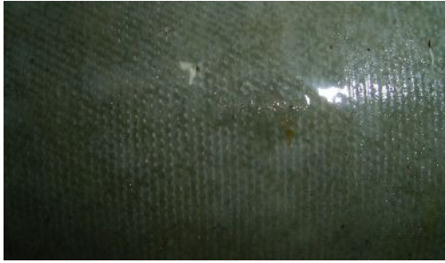
b) Beyazlaşma ve elyafların seçilmeye başlanması
