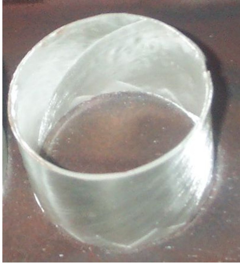
Şekil 5.2 \pm 55^\circ CTP boru yakma deneyi sonrası kalan elyafların görünümü
