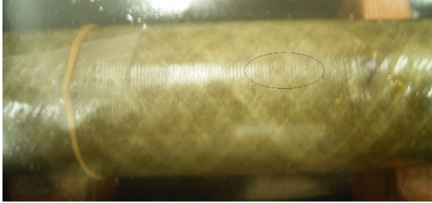
Şekil 5.14. Dört Katlı Cam Elyaf Kumaş Sargı Yama İle Tamir Edilmiş Boru
