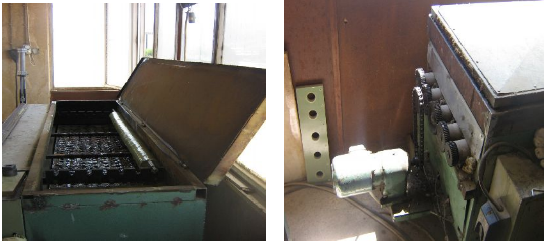
Şekil 5.1 Kür İşlemi Yapılan Döner Fırın ve Döndürme Mekanizması
