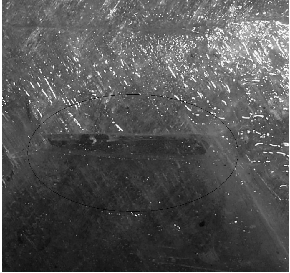
Şekil 6.5 İçten Kabuk Yama Yapılmış CTP Boru
