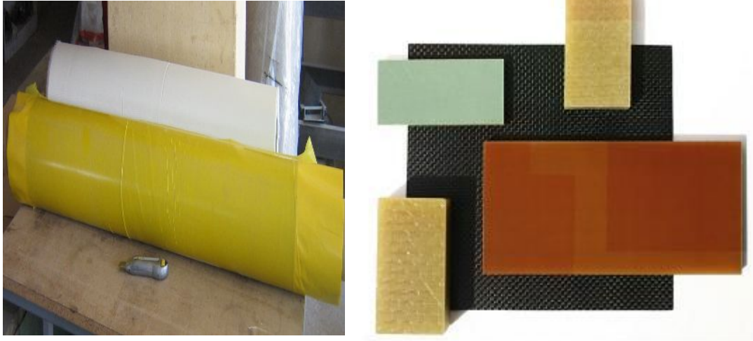
Şekil 5.11. Prepreg Malzemesinin Depolanmış Şekli ve Prepreg Örneği
