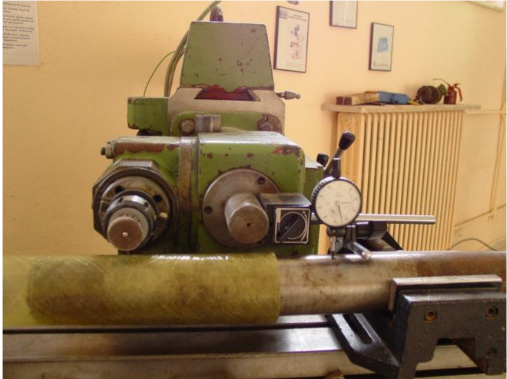
Şekil 5.4 Boru Üzerine Kalınlık Boyunca Çatlağın Freze Tezgahında Açılması
