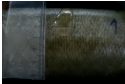
h) 1,9 MPa Basınç Altında Nihai Patlama
