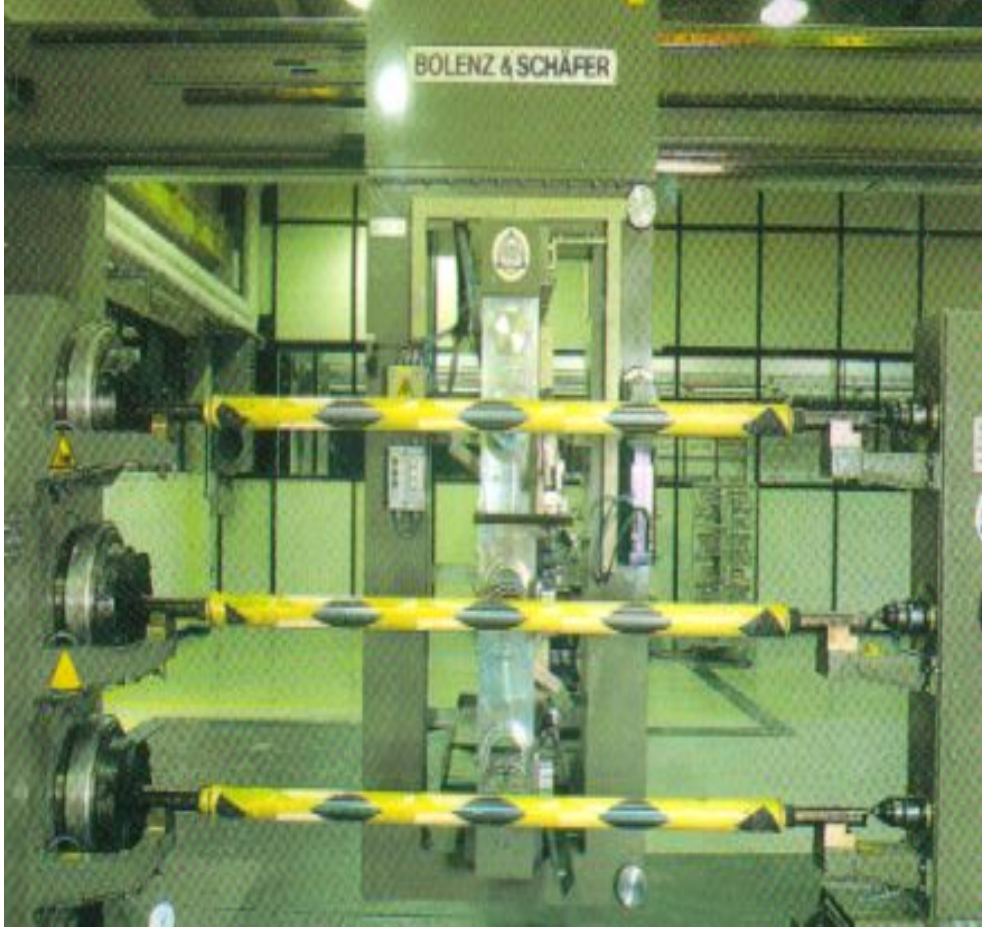
Şekil 3.4 4-Eksenli CNC filaman sargı makinesi
