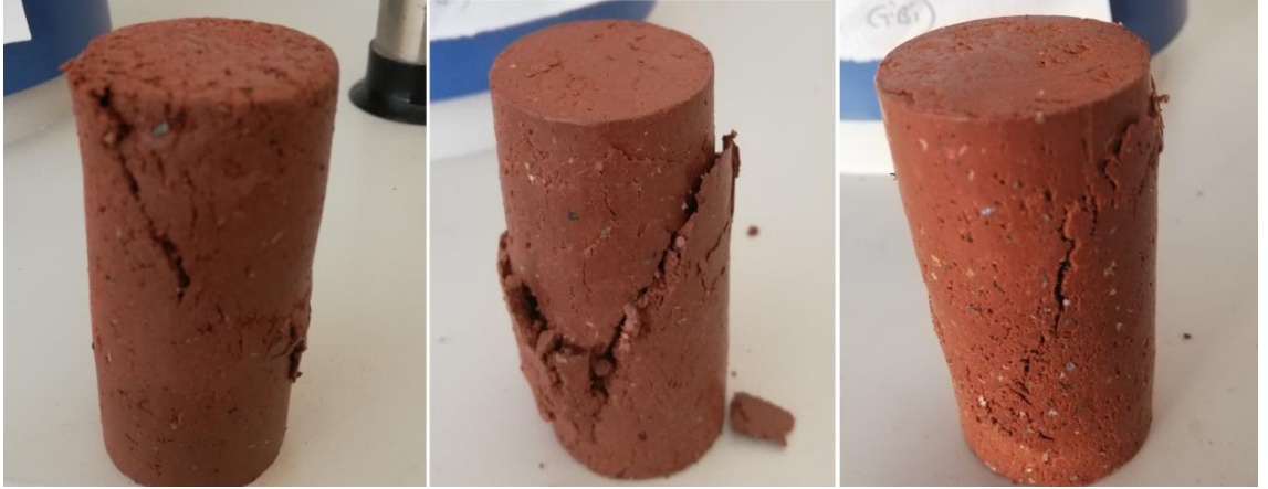
Şekil 4.11. Bazı numunelere ait kırılma şekilleri
