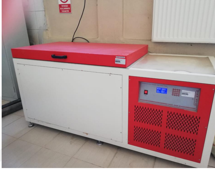
řekil 3.7. Donma-özölme deney aleti
