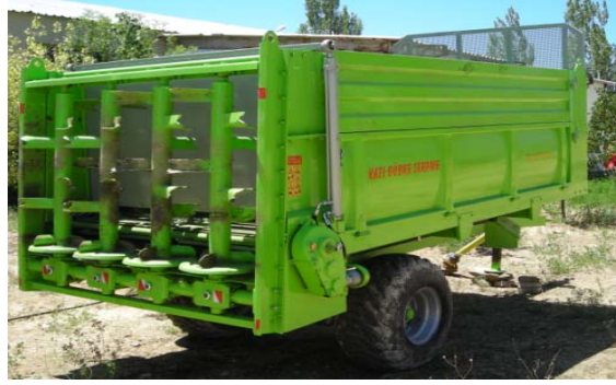
Şekil 8. Araştırmada kullanılan düşey dağıtıcı tamburlu çiftlik gübresi dağıtma makinası
