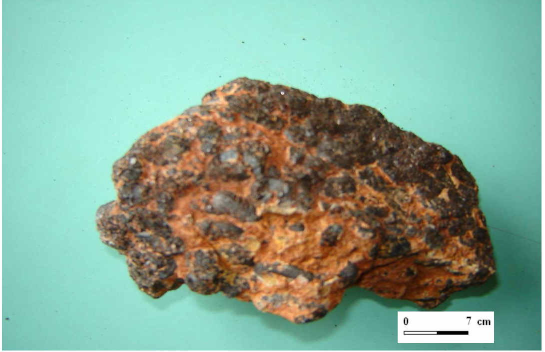
Şekil 3. 8. Nodüllerin sıkı bir şekilde bir araya gelmesiyle masif görünümü almış saçınımlı kromitten bir görünüm (Yer: Yürek ocağı).
