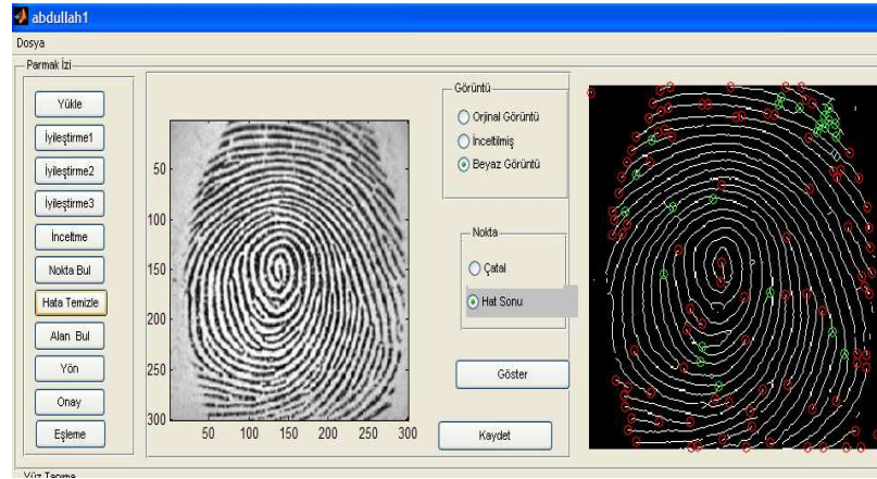
Şekil 6.7. Hatalı Noktaların temizlenmesi
