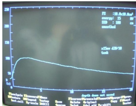
Şekil 5.11.a Derin doz eğrisinin çizdirilmesi(gürültüsüz).
