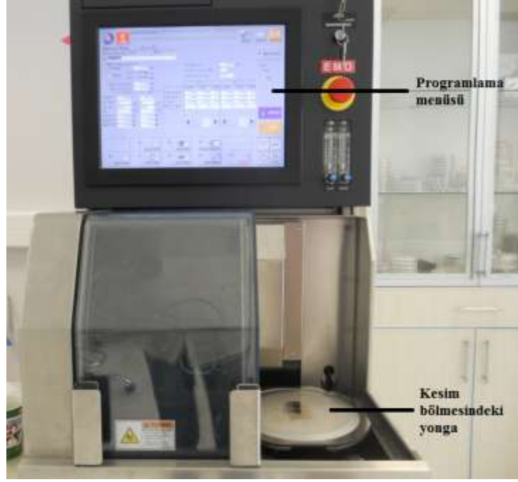
Şekil 3.27 Kesim programlama menüsü ve kesim bölgesindeki yonga
