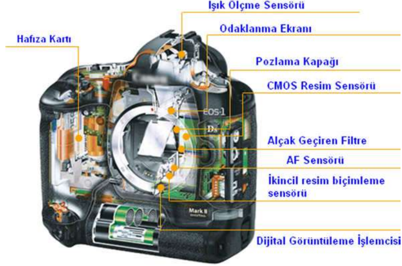
Şekil 1.4 Dijital SLR (Single Lens Reflex) kameranın yapısı (Anonim 2007)
