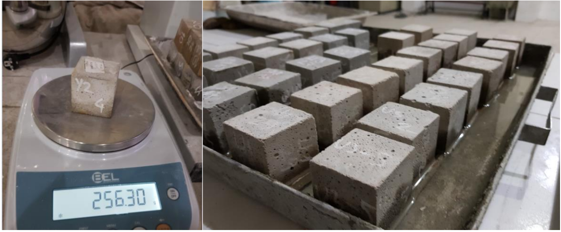
Şekil 48. Kılcal su emme direnci deneyi
