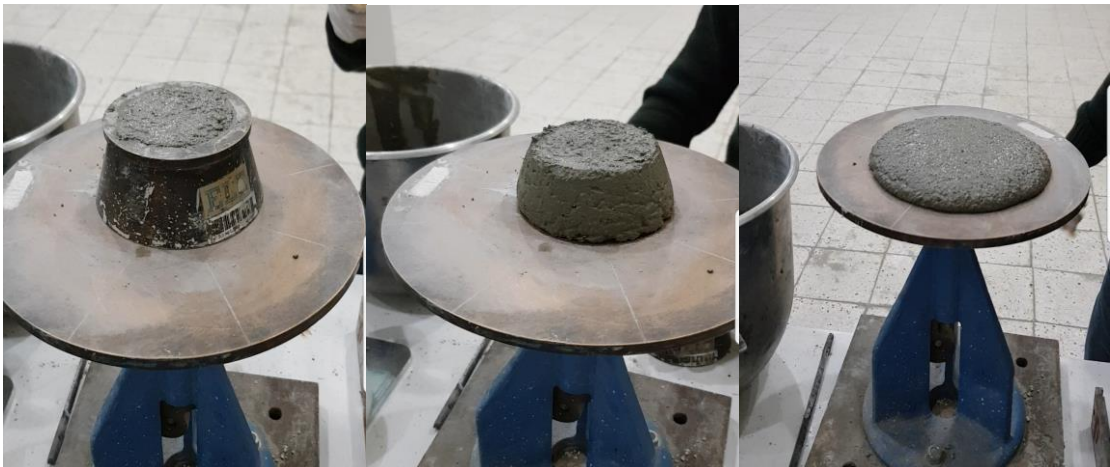
Şekil 46. Yayılma tablası ile kıvam tayini deneyi
