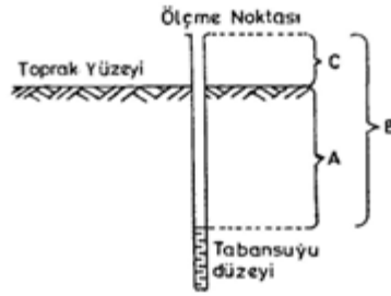
Şekil 3.4. Tabansuyu gözlem kuyusunda ölçüm parametreleri
