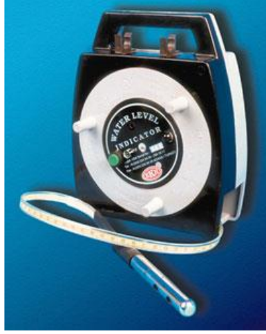
Şekil 3.3. Tabansuyu su seviyesi rasat aleti (Şeritmetre-Probometre)
