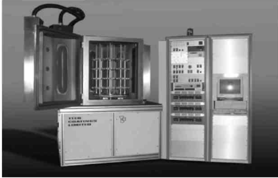
Şekil 5.12. PVD vakum kaplama makinesi örneği ( www.pvd-coatings.co.uk )
