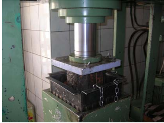
Şekil 3.4. Meyveden yağ çıkarılmasında kullanılan 200 tonluk hidrolik pres
