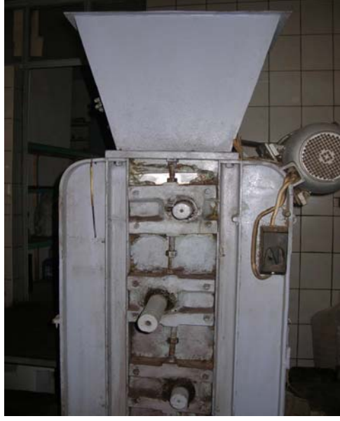
Şekil 3.2 Menengiç meyvesinin kırılmasında kullanılan kırma makinesi
