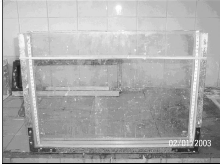
Şekil 3.14. Hazırlanan alçı modellere yük uygulanırken kullanılan üstü açık kutu şeklindeki cam düzeneği.
