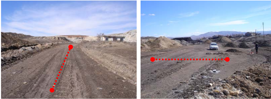
Şekil 5.4. Test lokasyonu-2’de bulunan pekişmiş yolun görüntüsü ve yerdirenci ölçüm hatları (Doğan, vd., 2007).
