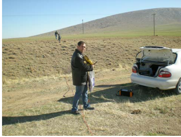
Şekil 6.15. Bozdağ tünelleri üzerinde yapılan arazi rezistivite ölçüm çalışmalarından bir görünüş.
