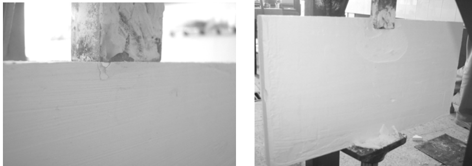
Şekil 3.28. Boşluksuz alçı model numuneler.
