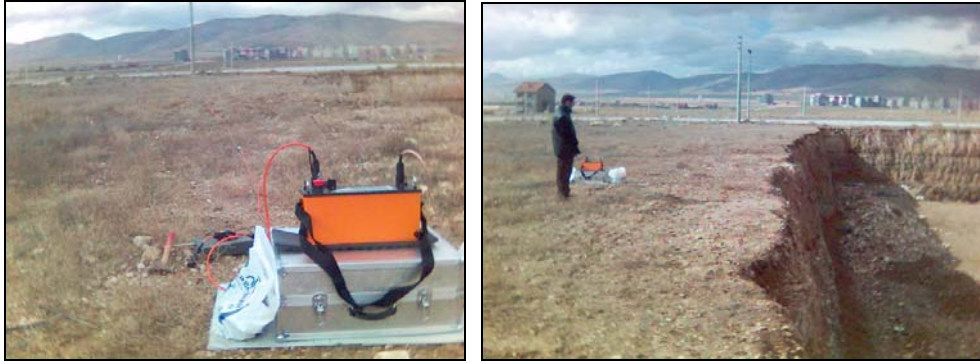
Şekil 4.14. Konya-Binkonutlar semtindeki yerdirenci ölçümleri.
