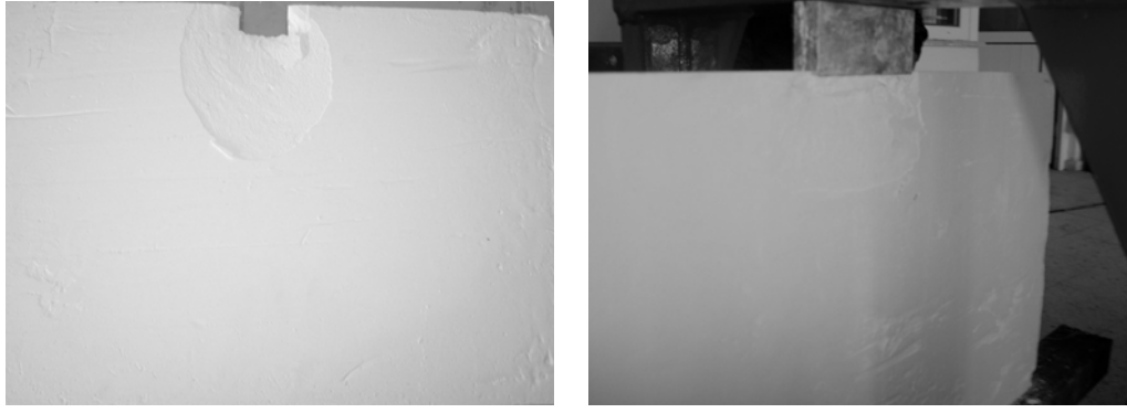
Şekil 3.29. Boşluksuz alçı numunelerin yük altında çatlatılma sonrası durumları.
