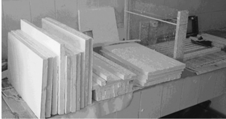
Şekil 3.2. Yeraltında açılan galeri çevresindeki elektriksel dağılımın incelenmesi amacıyla hazırlanmış olan alçı modeller (Gökay, 2009) .
