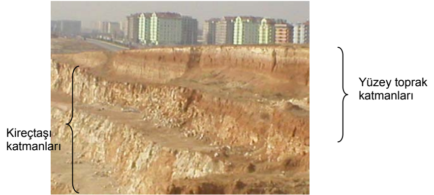
Şekil 1.2. Elektriksel yerdirenci ölçüm çalışmalarında toprak altında kaya yüzeyinin algılanmasına yönelik yapılan ilk uygulamaların yapıldığı arazi lokasyonlardan birisi, (Binkonut-Konya). Bu bölgede kayaç yüzeyi 5-30 metre derilikte yer almaktadır.
