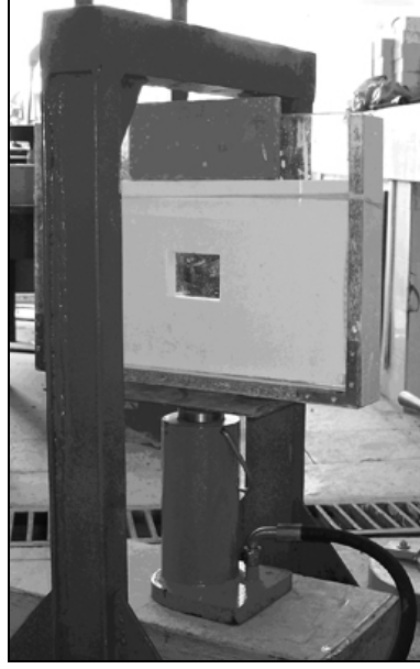
Şekil 3.24. Dikdörtgen kesitli galeri modelinin hidrolik preste yüklenmesi.
