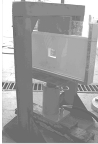
Şekil 3.20. Kare galeri kesitli arazi modellemesi. Hidrolik presin uygulandığı an.
