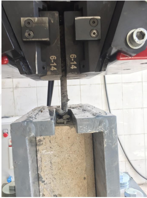
Şekil 3.16. Kaya saplama çekme deneyi
