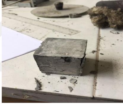
Şekil 3.12. Dolgu malzemesi (grout) numunesi (kırılma Sonrası)
