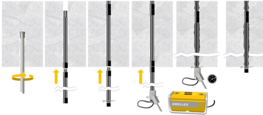
Şekil 2.14. Swellex kaya saplama montajı (Konietzky and Frühwirth 2018)
