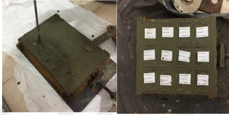
Şekil 3.10. Dolgu malzemesinin hazırlanması ve kalıplara konulması
