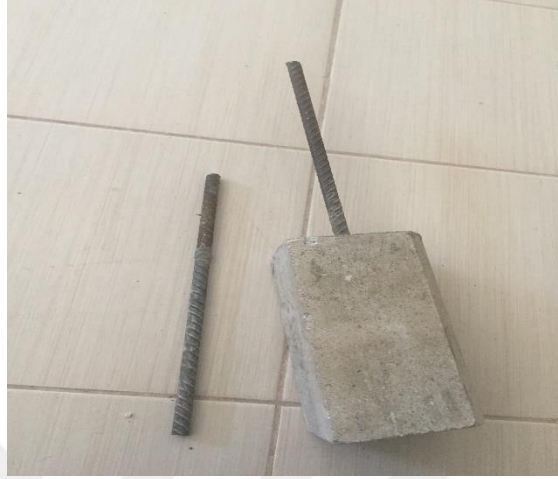
Şekil 3.2. 12 mm çapında nervürlü donatı
