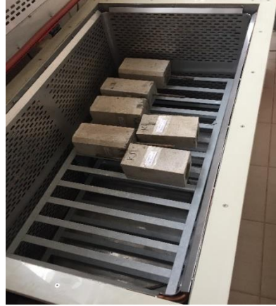
Şekil 3.15. Donma çözülme kabinine koyulan kaya saplama numuneleri
