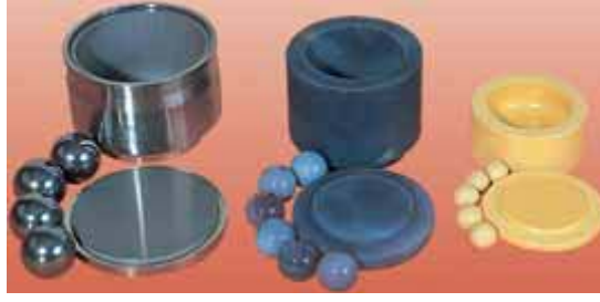
Şekil 1.14. Fritsch Pulverisette değirmende kullanılan hazneler ve bilyeler (Fritsch, 2009).
