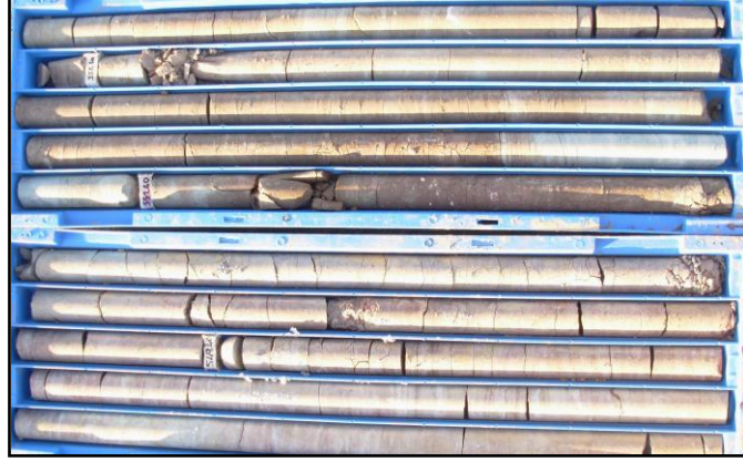
Şekil 2.16. Acıkuyu sondajında izlenen Kızılbayır formasyonuna ait bordo renkli kumtaşı, silttaşı.
