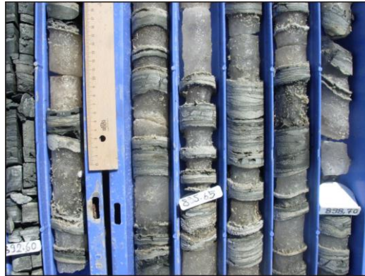
Şekil 4.10. Katrandedetepe formasyonunun alt seviyelerinde gözlenen halit, laminalı karbonat, anhidrit, globerit, kiltası ardalanması.
