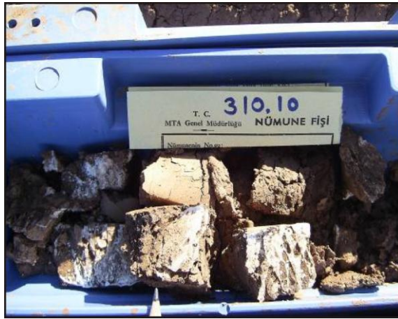
Şekil 2.43. Beştepeler formasyonu kırıntılı birimleri ve içerisindeki kılcal tuzlanmalar.
