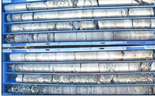
Şekil 2.34. Acıkuyu sondajının üst seviyelerinde gözlenen ince laminalı kıltaşı-jips-marn-dolomit ardalanması.
