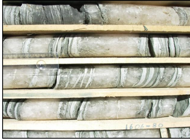
Şekil 2.31. Çukurkuyu sondajının alt seviyelerinde gözlenen halit, laminalı manyezit, anhidrit, globerit, kiltashi ardalanması.
