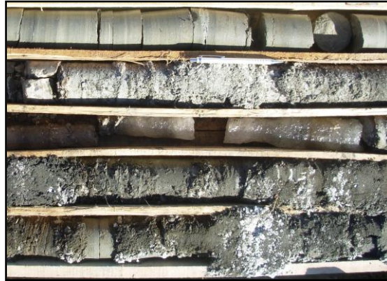
Şekil 2.33. Yeniköy sondajının 475 ve 567m ler arasında gözlenen halit, petrollü şeyl, anhidrit-jips-globerit ardalanması.
