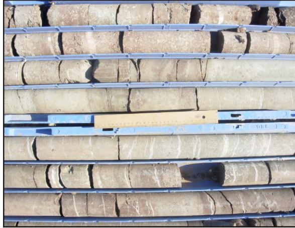
Şekil 2.45. Seslikaya sondajı 230.90-500m arasında kumtaşı, silttaşı ve kiltası içerisinde 1-2cm kalınlıkta, 10cm-1m aralıklarla tekrarlanmalı beyaz lifsi jips bantları ve nodülleri.
