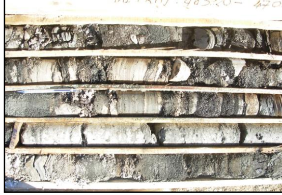
Şekil 2.32. Yeniköy sondajının üst seviyelerinde gözlenen ince laminalı, jips kristalli ve bantlı, tuzlu kiltası ile anhidrit, dolomit, petrollü şeyl ardalanması.
