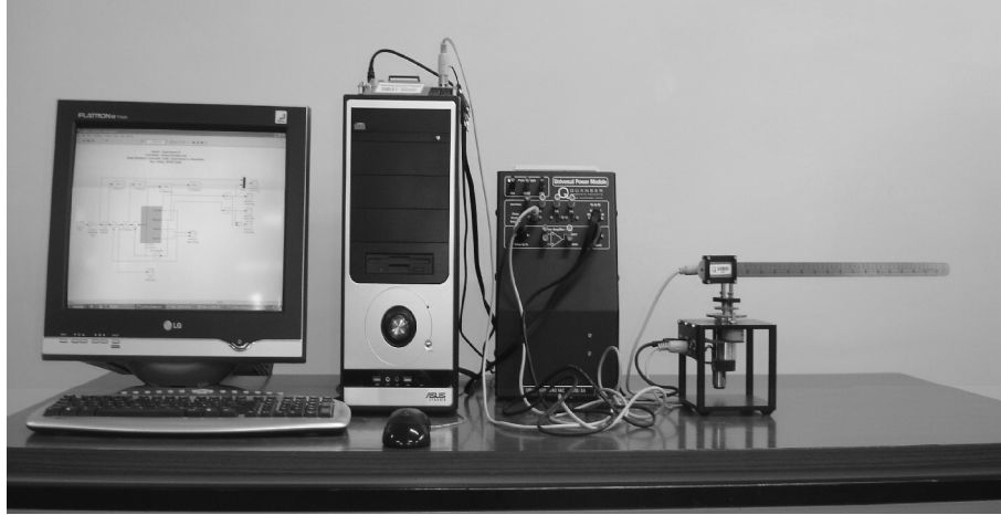
Şekil 6.1 Tek elastik uzuvlu robot manipülatör sisteminin deney düzeneği.
