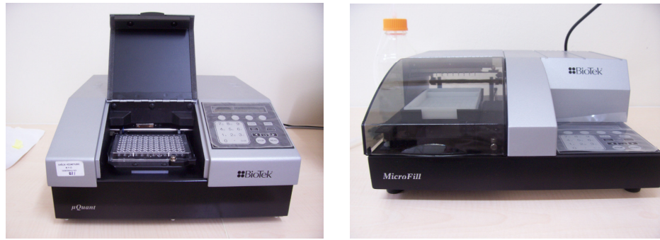
Şekil 3. 3. Çalışmada kullanılan mikropılaka okuyucu ve otomatik dispenser
